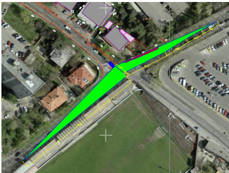
Slika 51: Duljina preglednosti za skretače u lijevo prema HR normi
