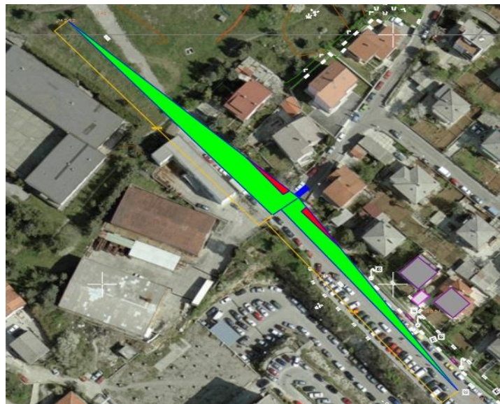
Slika 43: Duljina preglednosti za skretače u lijevo prema US normi
