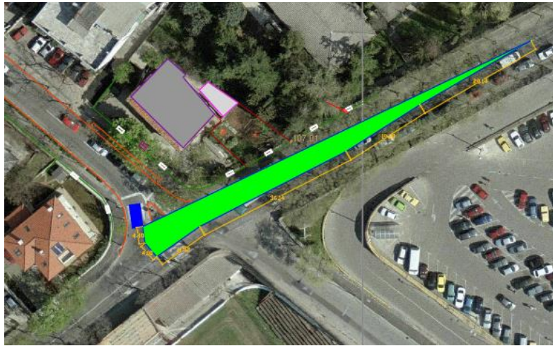
Slika 50: Duljina preglednosti za skretače u desno prema US normi
