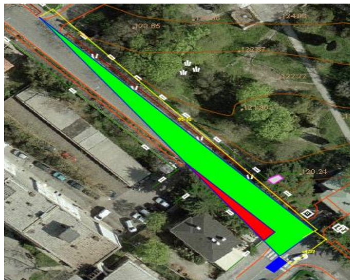
Slika 36: Duljina preglednosti za skretače u drugu desnu prema US normi
