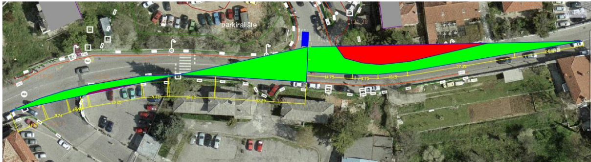
Slika 29: Duljina preglednosti za lijeve skretače prema US normi
