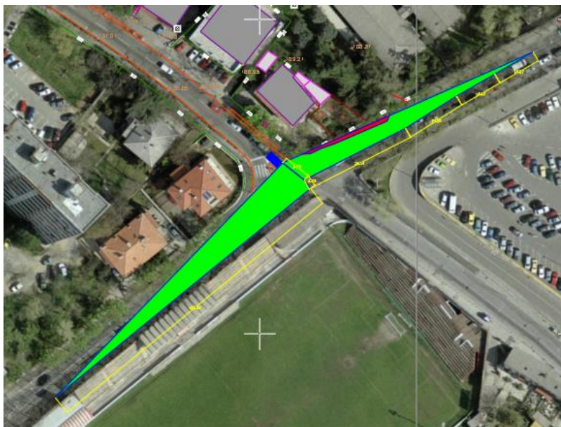
Slika 51: Duljina preglednosti za skretače u lijevo prema HR normi
