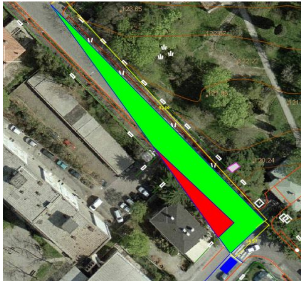
Slika 34: Duljina preglednosti za skretače u drugu desnu prema HR normi
