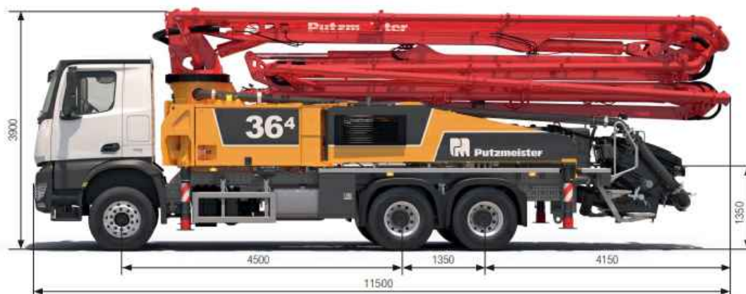
Predviđena autopumpa - Putzmeister M36-4
