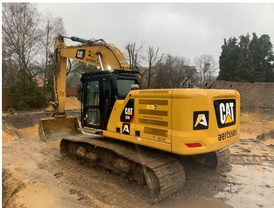
Slika 3. Bager gusjeničar Caterpillar 330 (TRUCK 1. EU)
