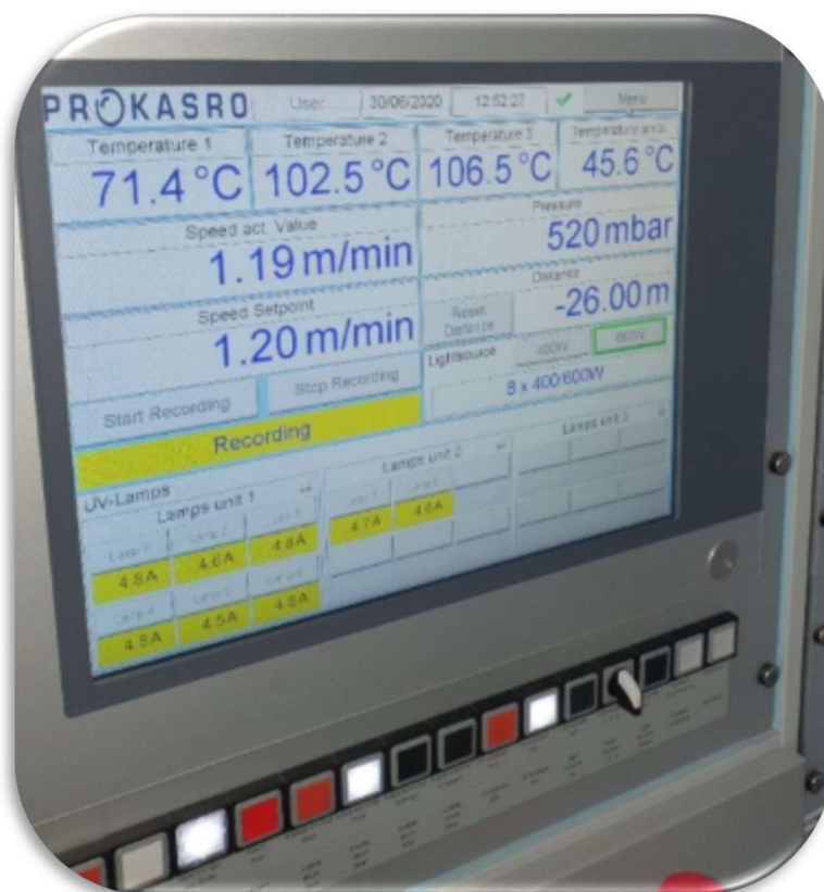
Slika 31 : Proces polimerizacije vođen računalom [11]
