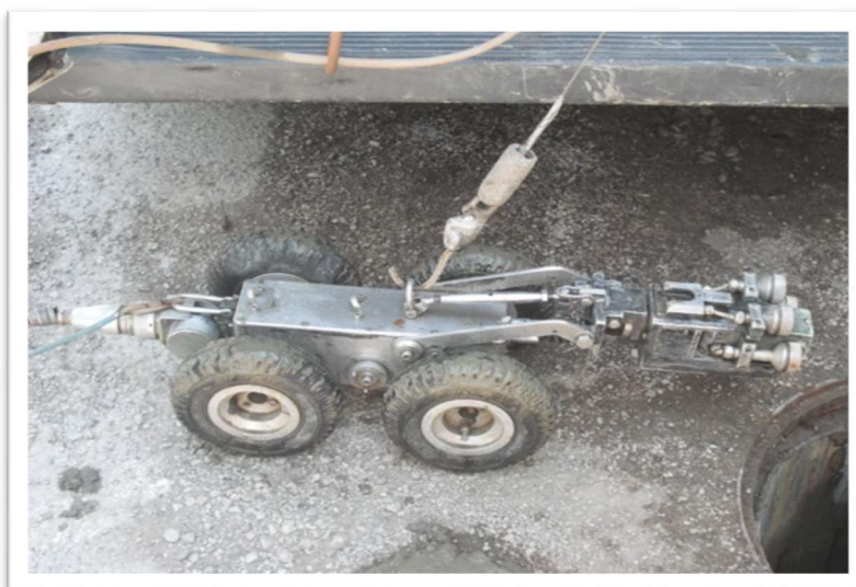
Slika 7 : Robot kamera na daljinsko upravljanje [10]
