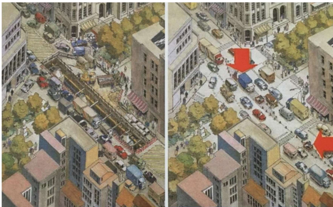
Slika 5 : Slika sa metodom iskopa i metodom bez iskopa na križanju [5]
