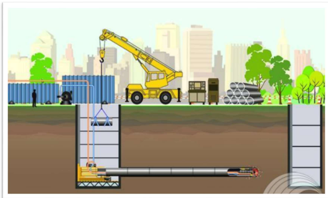
Slika 19 : Strojni iskop punog profila [5]
