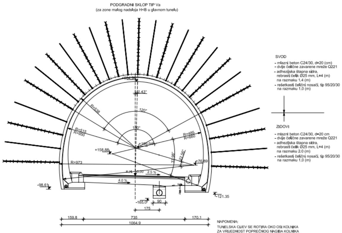
Slika 42. Podgradni sustav TIP Va [17]
