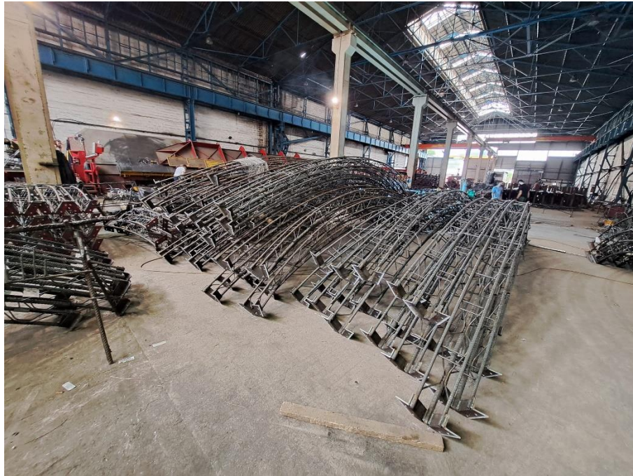
Slika 48. Prikaz čeličnog rešetkastog nosača [24]
