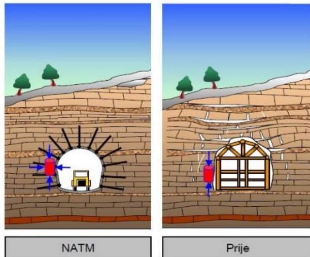
Slika 12. Formiranje troosnog stanja naprezanja [3]
