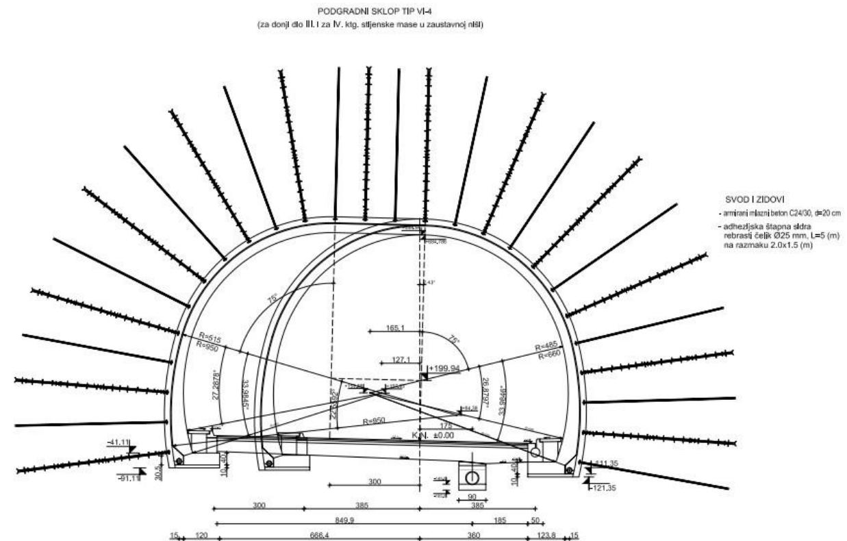
Slika 45. Podgradni sustav TIP VI-4 [17]
