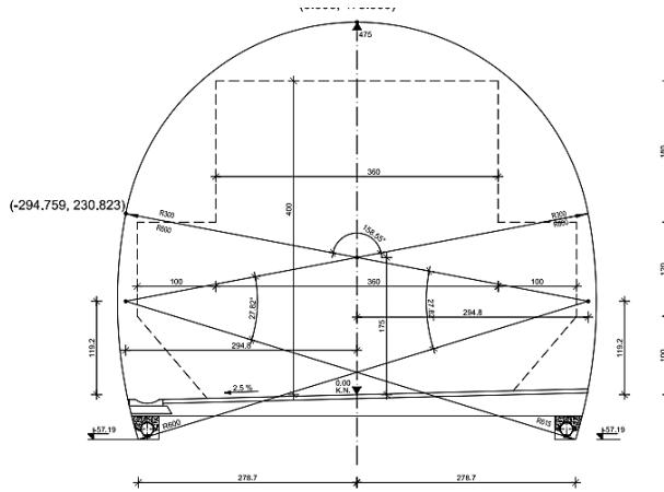
Slika 36. Konstrukcija unutrašnje linije servisnog tunela „Debeli Brijeg“ [17]
