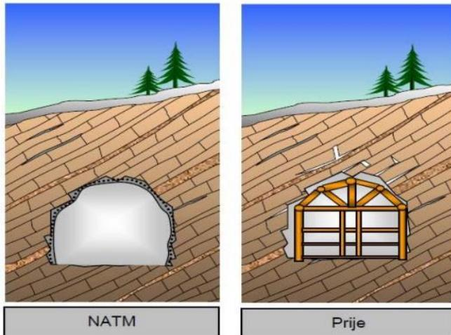
Slika 17. Upotreba mlaznog betona umjesto drvene podgrade [3]
