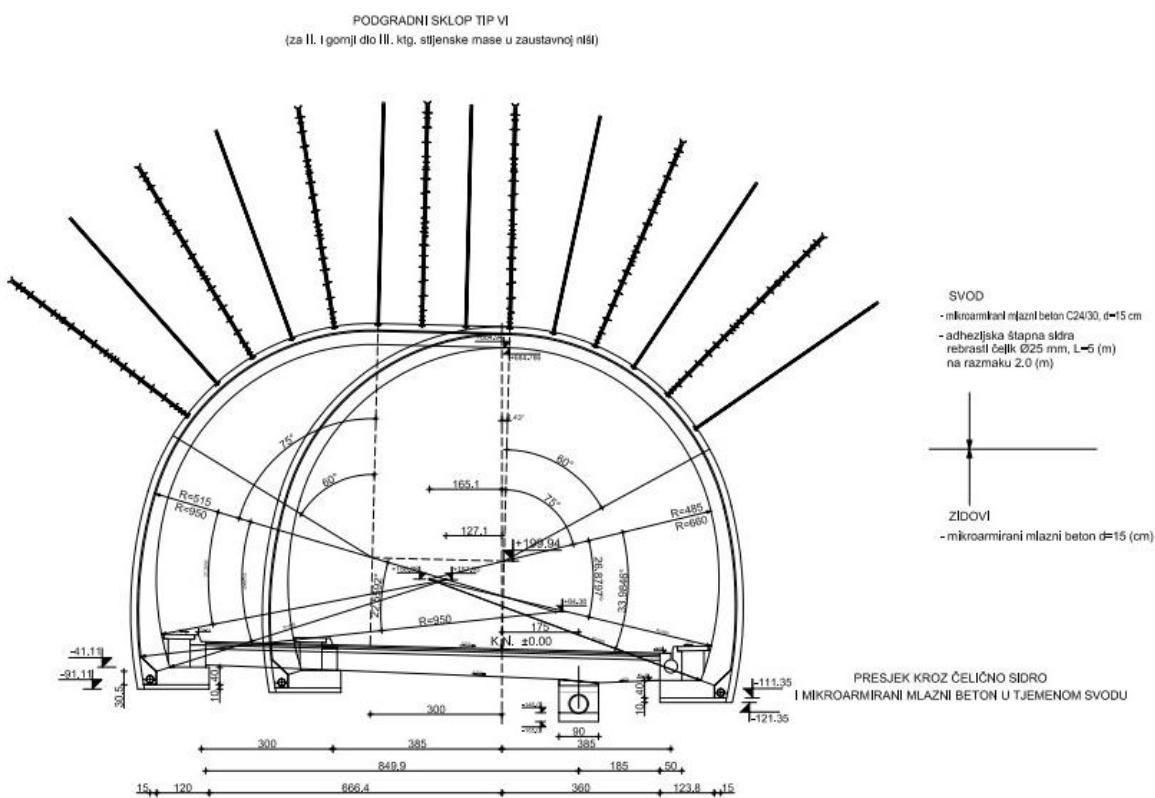
Slika 44. Podgradni sustav TIP VI [17]
