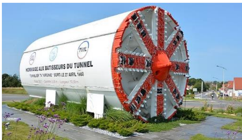
Slika 3. Stroj za iskop u punom profilu [20]
