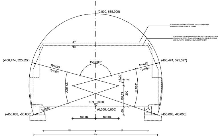
Slika 35. Konstrukcija unutrašnje linije glavnog tunela „Debeli Brijeg“ [17]
