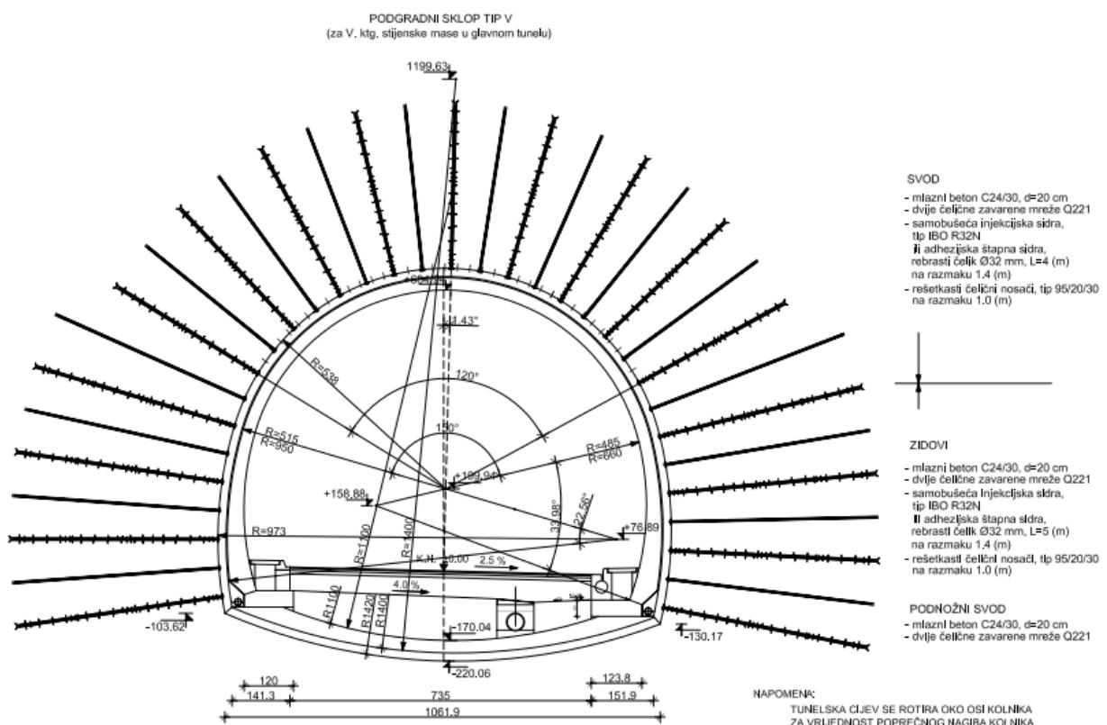
Slika 41. Podgradni sustav TIP V [17]
