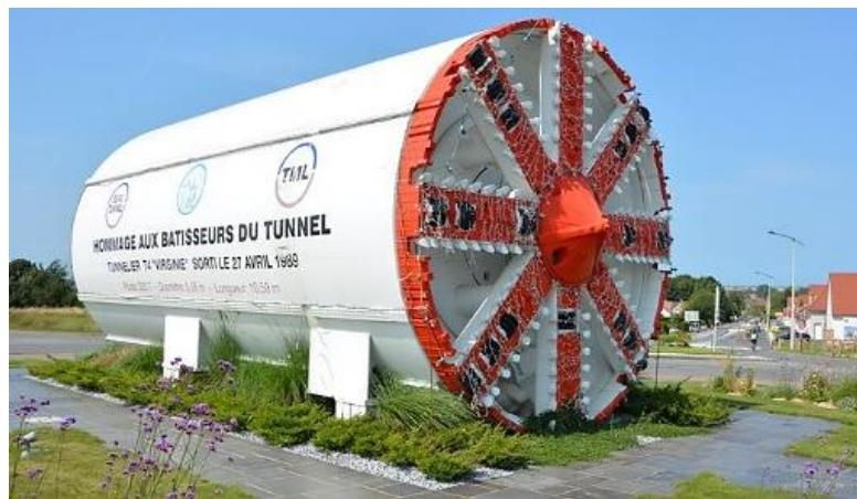
Slika 3. Stroj za iskop u punom profilu [20]
