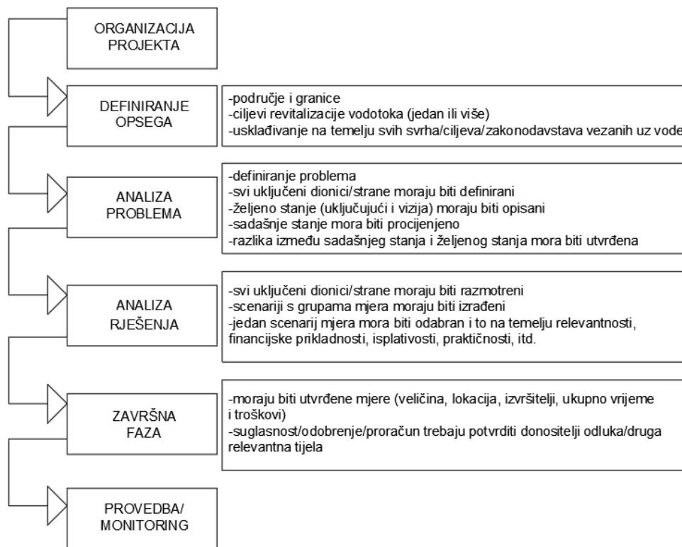
Slika 15: Opća shema izrade Plana revitalizacije vodotoka
