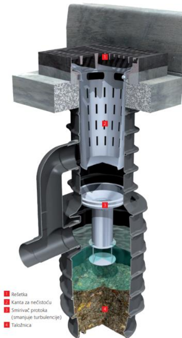
Slika 13 Combipoint PP cestovni slivnik firme ACO [15]
