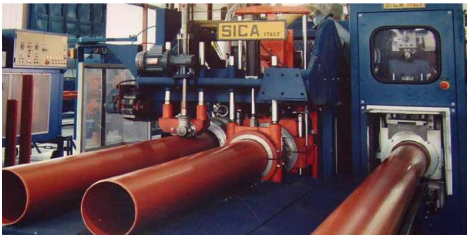
Slika 7 Postrojenje za proizvodnju PVC cijevi [5]
