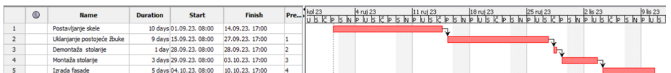
Slika 20 izvedba radova sva pročelja od jednom (izradio autor)
