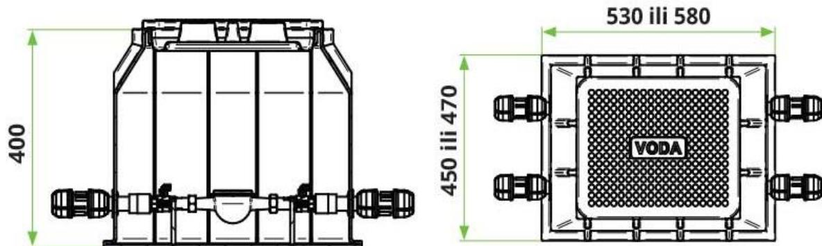
Slika 7: Vodovodni kućni priključak (izvor: <https://roto-grad.hr/vodomjerno-okno-quadroto/>)
