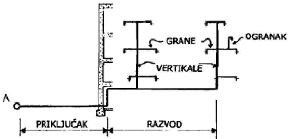
Slika 8: Osnovna shema kućnog vodovoda (izvor: [1])
