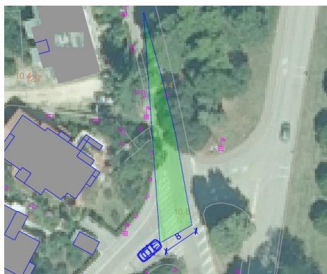
Slika 17. Provjera preglednosti na Ulici Anke Butorac
