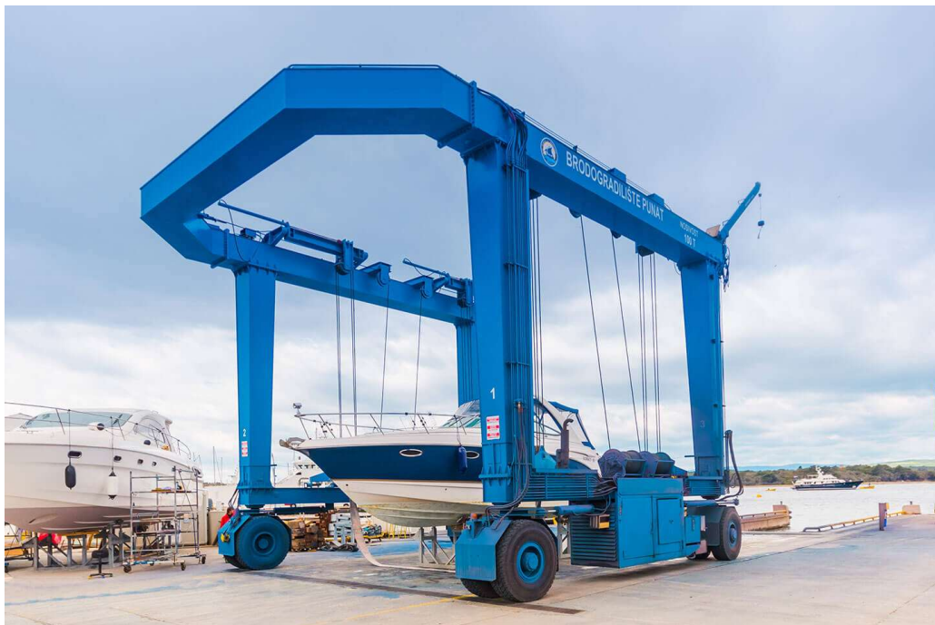
Slika 3: Izvlačenje plovila sa Travel liftom od 100 tona [13]
