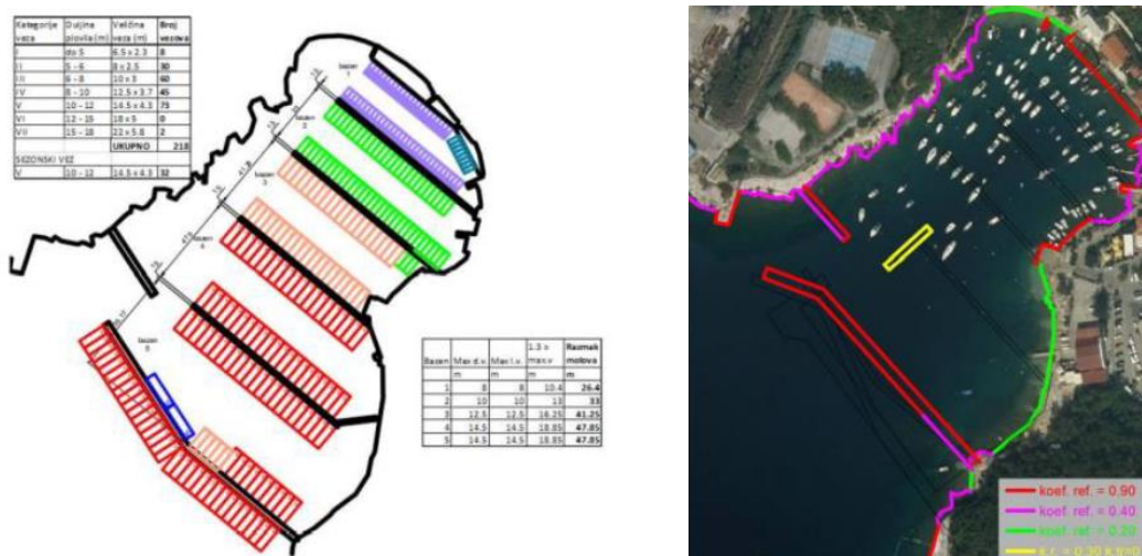
Slike 11 i 12: Varijantna rješenja 2 i 3 lukobrana i gatova (Izvor: MareCon d.o.o; Idejno rješenje, Rekonstrukcija luke Kostrena, bazen Žurkovo)
