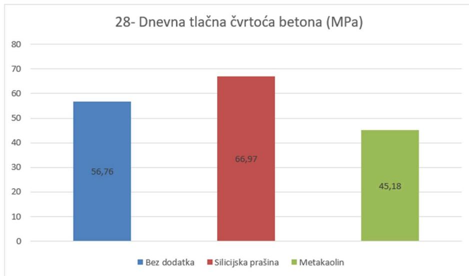
Slika 14: Prikaz usporedbe srednjih vrijednosti tlačnih čvrstoća uzoraka
