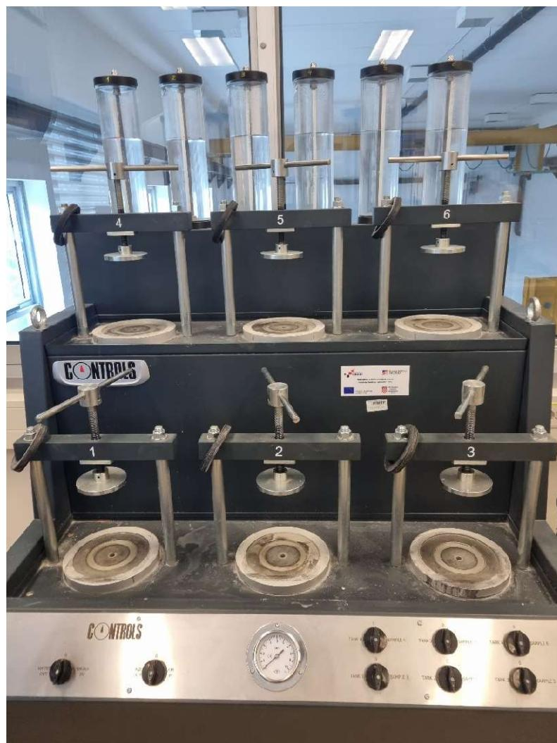
Slika 11: Uredaj za ispitivanje vodopropustnosti (izvor: vlastita fotografija)
