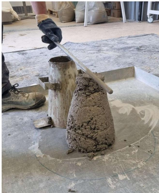
Slika 6: Ispitivanje konzistencije slijeganjem (izvor: vlastita fotografija)
