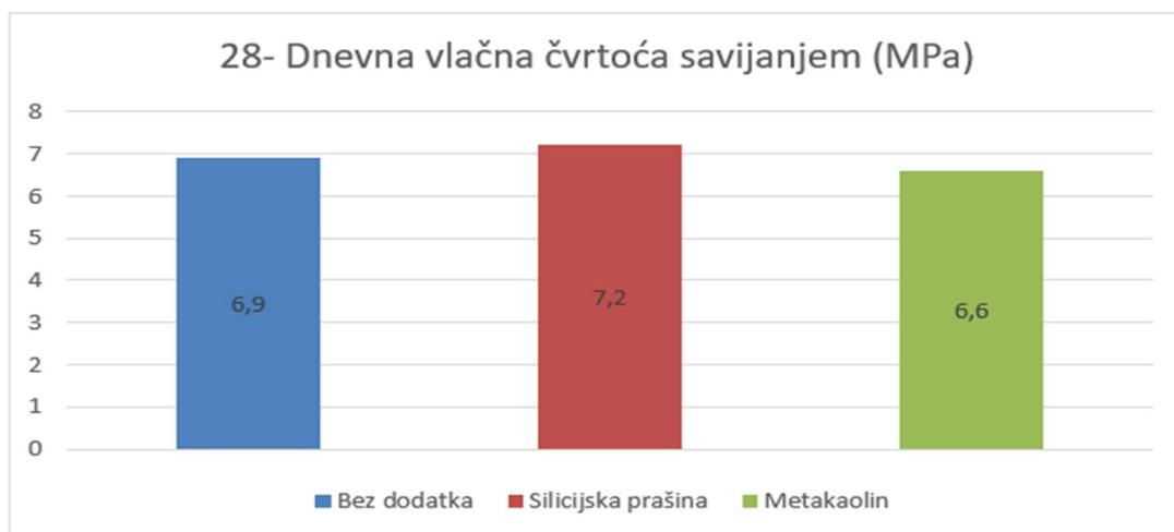
Slika 15: Prikaz srednjih vrijednosti vlačnih čvrstoća savijanjem
