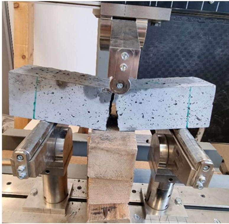
Slika 9: Vlačna čvrstoća savijanjem (izvor: vlastita fotografija)
