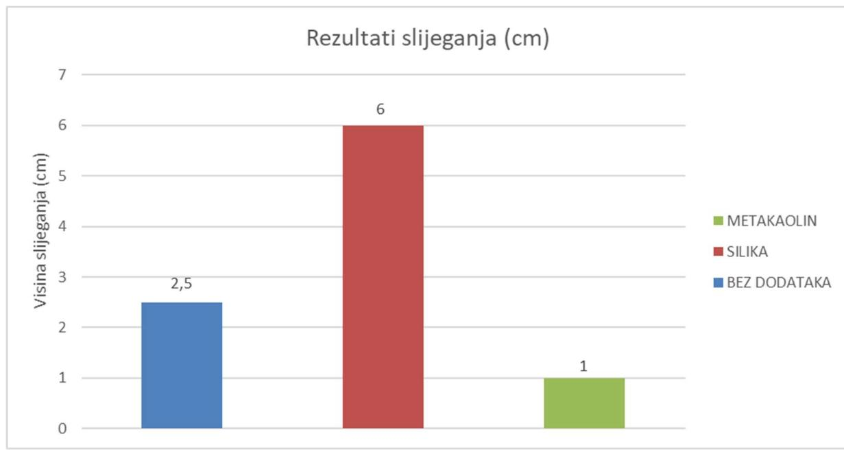
Slika 13: Prikaz rezultata dobivenih ispitivanjem slijeganjem
