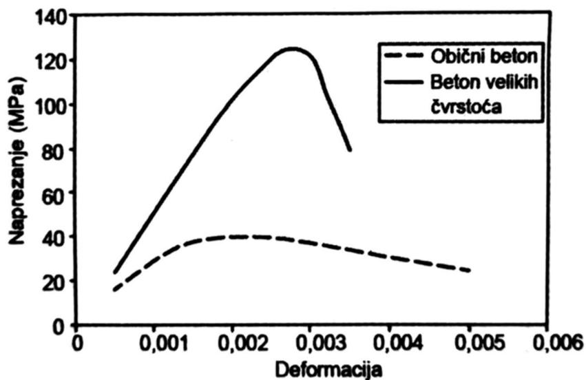
Slika 4: Usporedba idealiziranih krivulja naprezanja-deformacija (izvor: [4])
