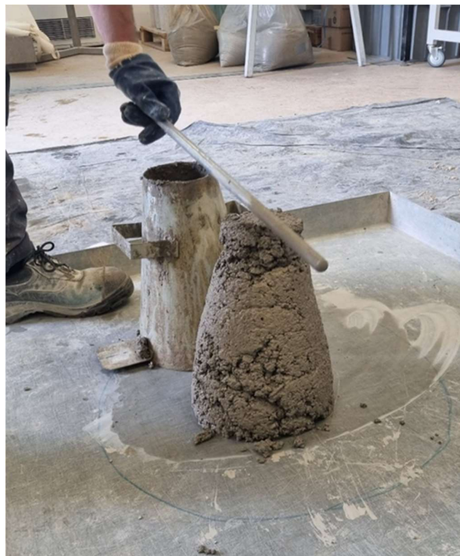
Slika 6: Ispitivanje konzistencije slijeganjem (izvor: vlastita fotografija)
