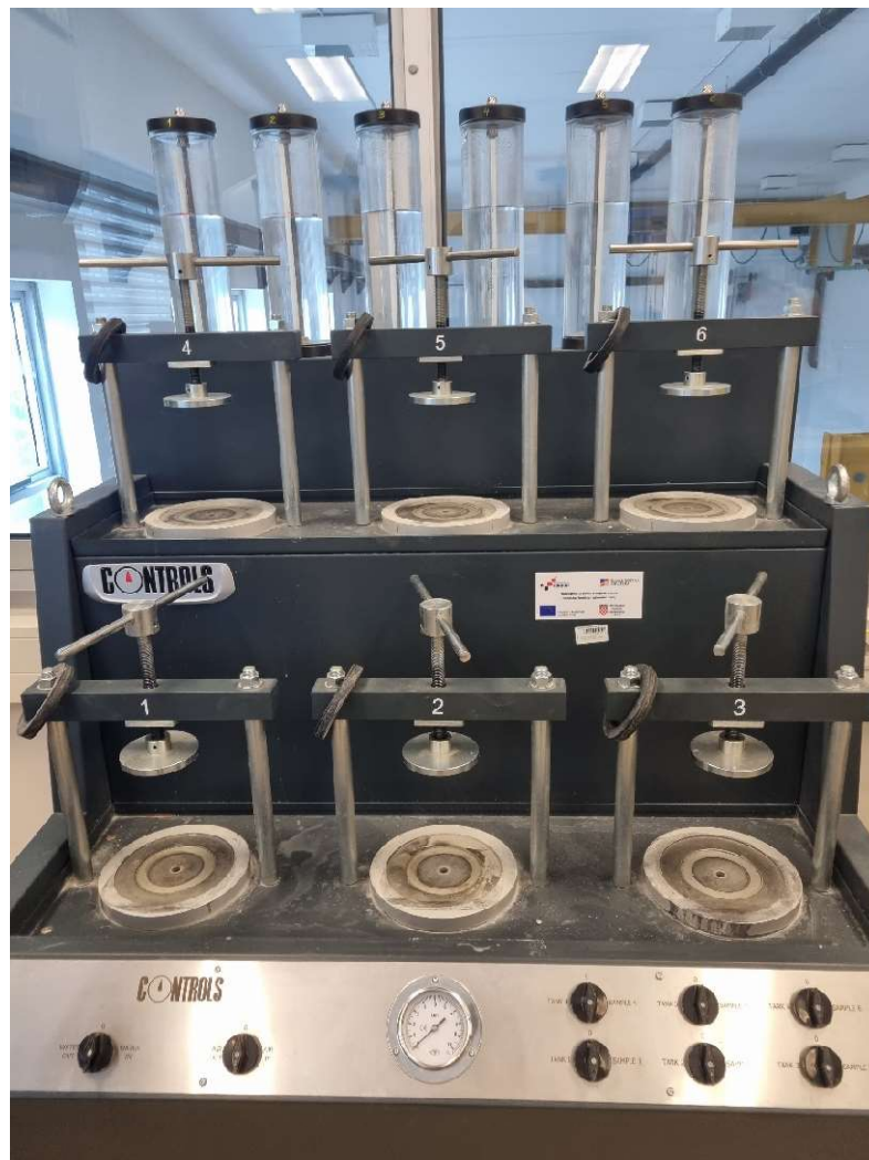
Slika 11: Uređaj za ispitivanje vodopropustnosti (izvor: vlastita fotografija)
