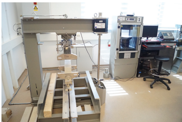
Slika 2. Uređaj za multifunkcionalno ispitivanje građevnih materijala i proizvoda
