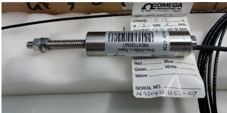
Slika 3. AC LVDT s nominalnim hodom \pm 5 mm
