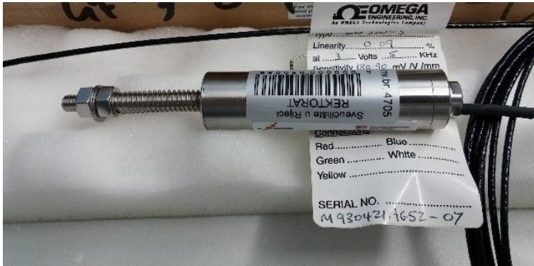
Slika 3. AC LVDT s nominalnim hodom \pm 5 mm
