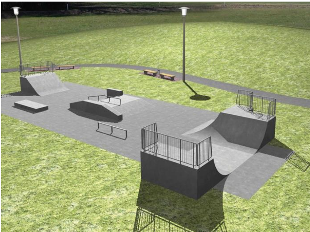
Slika 126: Primjer prefabriciranih betonskih elemenata skate parka [104]
