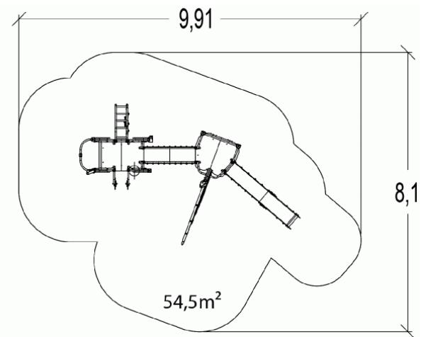
Slika 104: Tlocrt kombinirane sprave za igru za djecu iznad tri godine [82]
