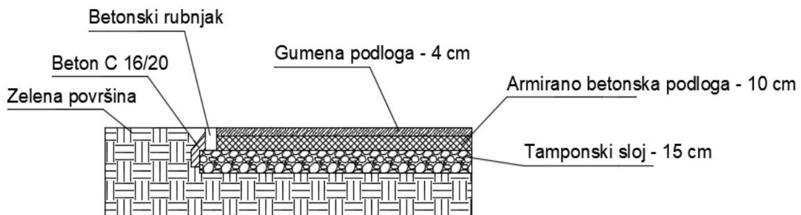
Slika 86: Detalj antistres gumene podloge [izradio: autor]
