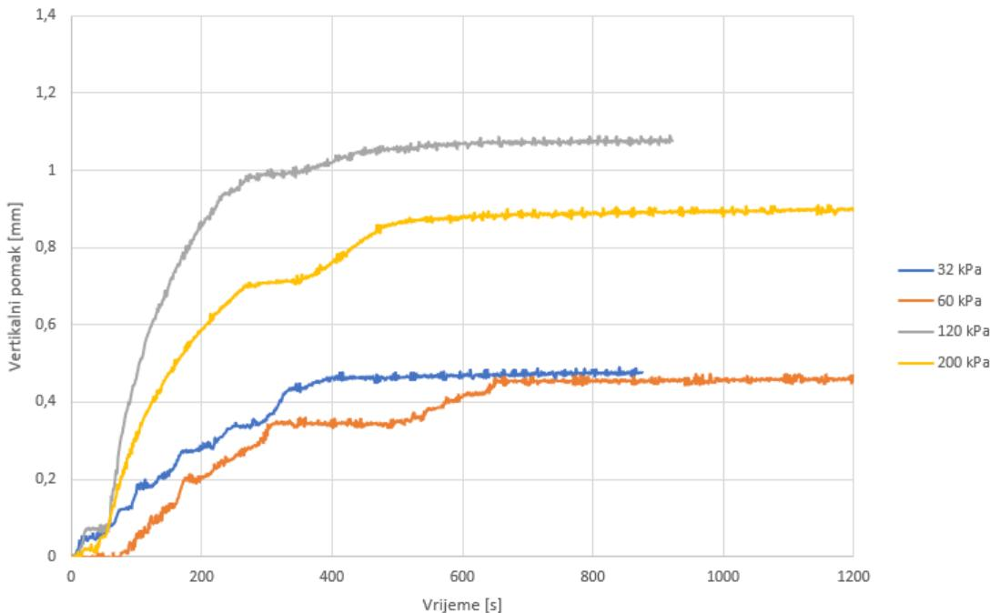
Slika 17.: Vertikalni pomak u vremenu tijekom konsolidacije
