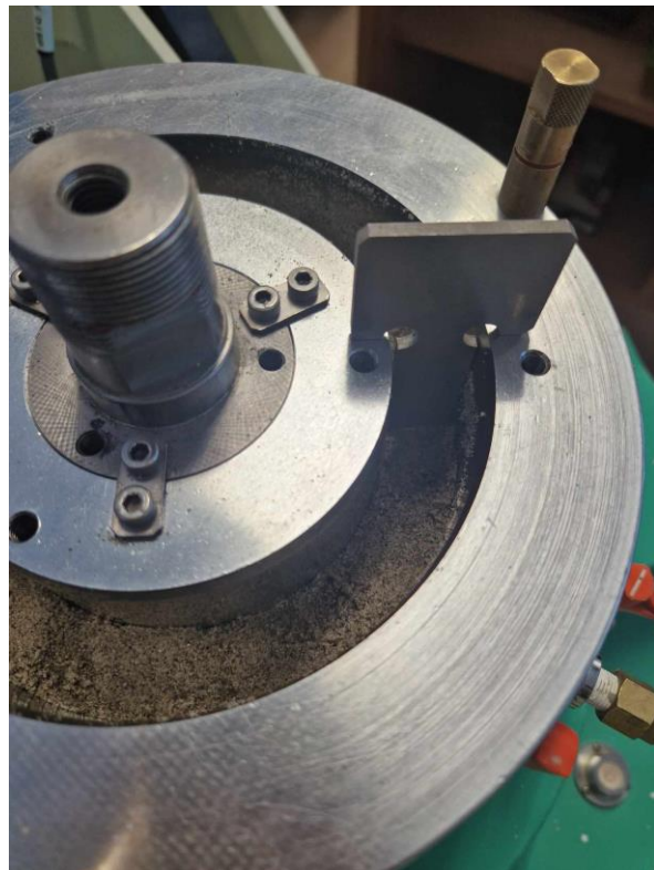
Slika 10. Postupak izravnavanja uzorka nožićem
