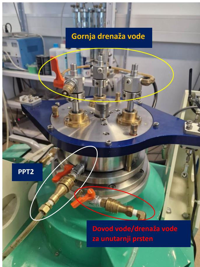
Slika 8.: Prikaz ventila, drenaže i mjerača pornih pritisaka
