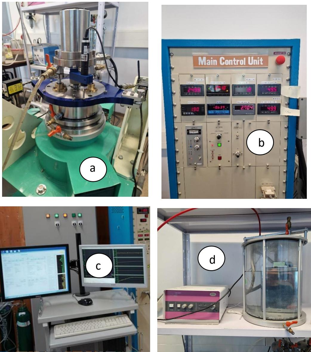
Slika 4.: Dijelovi uređaja za prstenasto smicanje: a – instrumentalna jedinica, b – nadzorna jedinica, c – kontrolna jedinica, d – sustav za deaeriranje vode [6]
