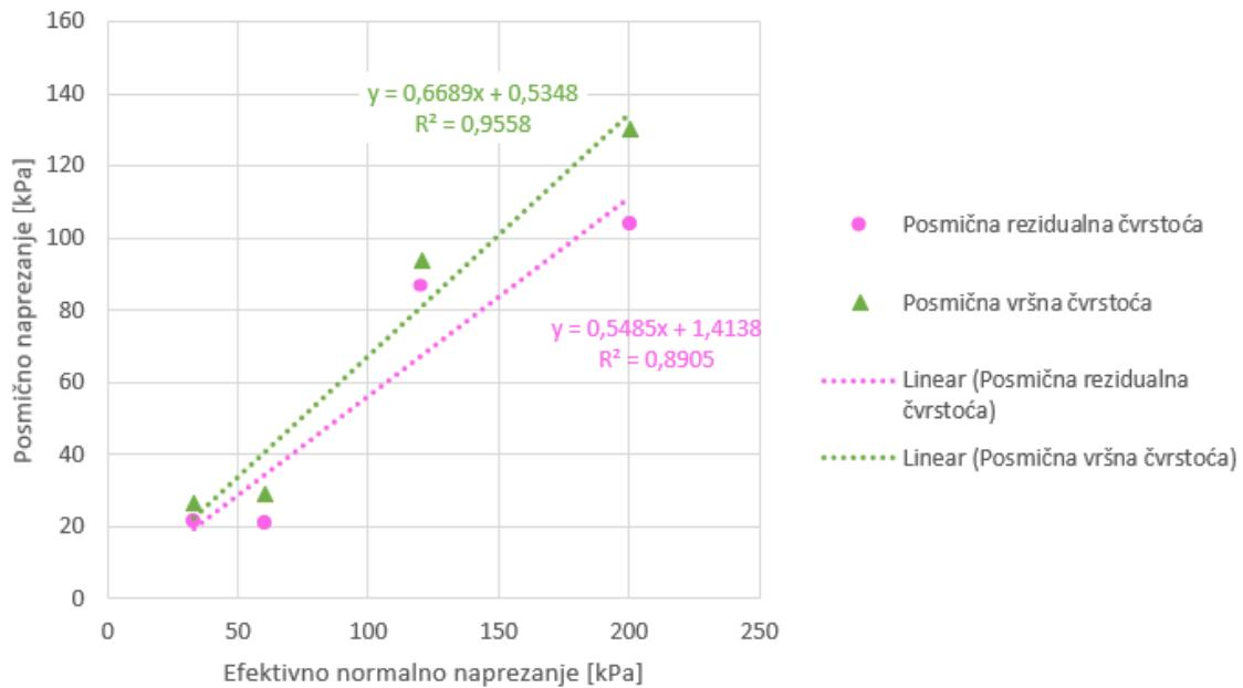
Slika 21.: Mohr-Coulombovi pravci vršne i rezidualne čvrstoće
