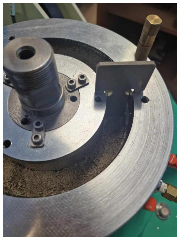
Slika 10. Postupak izravnavanja uzorka nožićem
