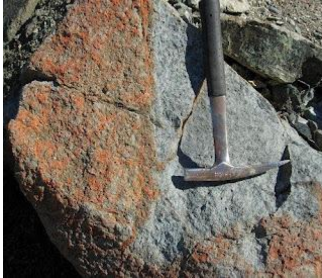
Slika 8. Primjer kemijskog trošenja stijene ( http://claremontgeography12.blogspot.com/2011/02/oxidation.html )
