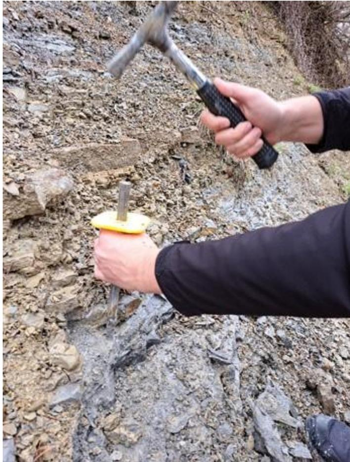
Slika 10. Uzimanje uzoraka za laboratorijsko ispitivanje s kosine.
