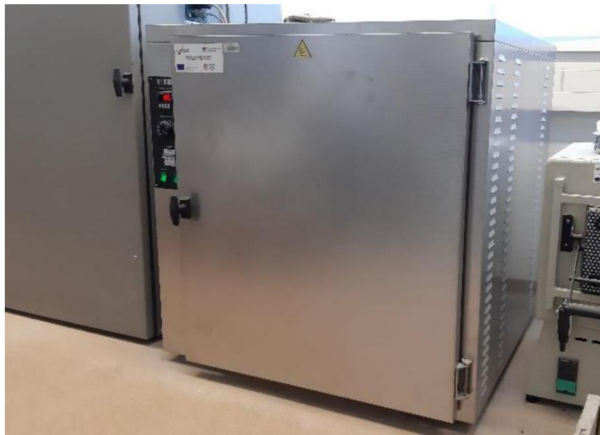
Slika 12. Sušionik za sušenje ispitivanih uzoraka (Jakić, 2019)
