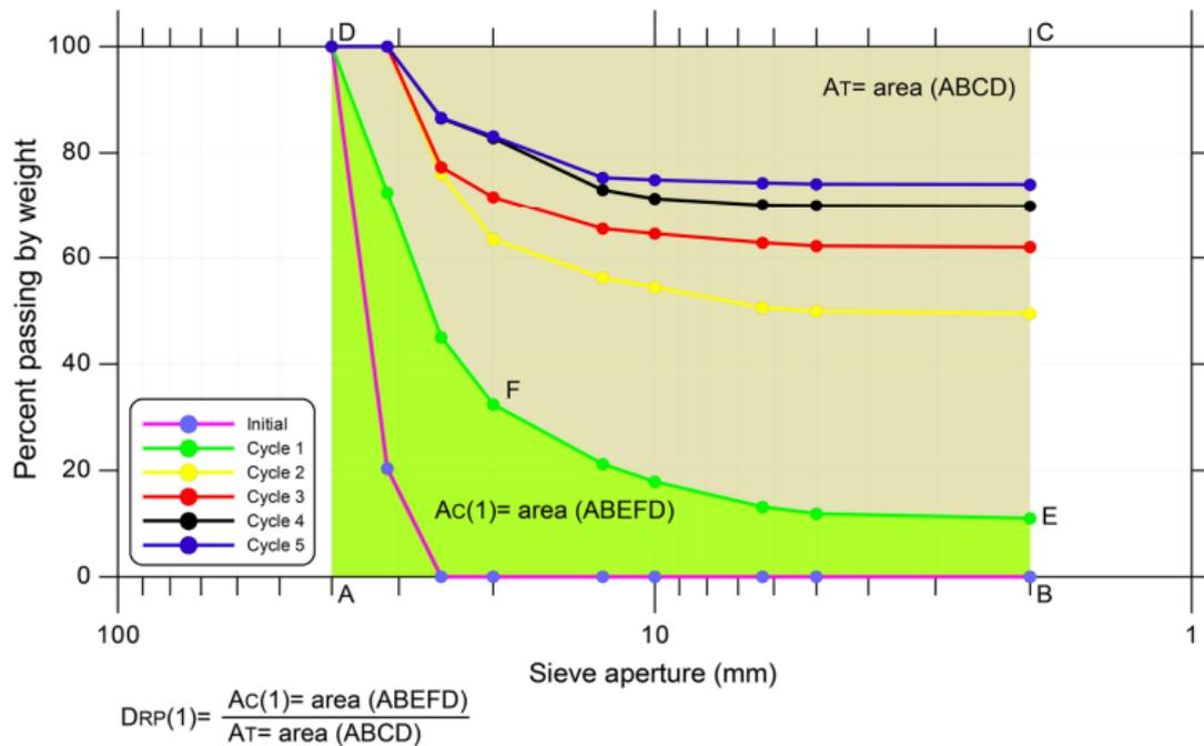
Slika 15. Primjer određivanja omjera  $D_{RP}$  nakon 1. ciklusa (Cano i Tomas, 2016)
