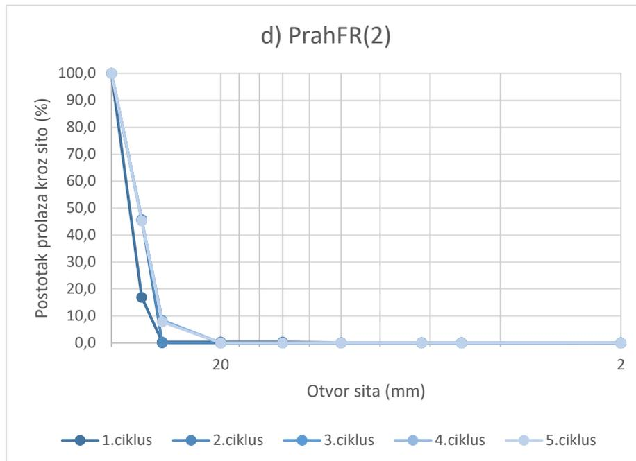
Slika 18. Granulometrijske krivulje uzoraka c) PrahMW(1), d) PrahFR(2)
