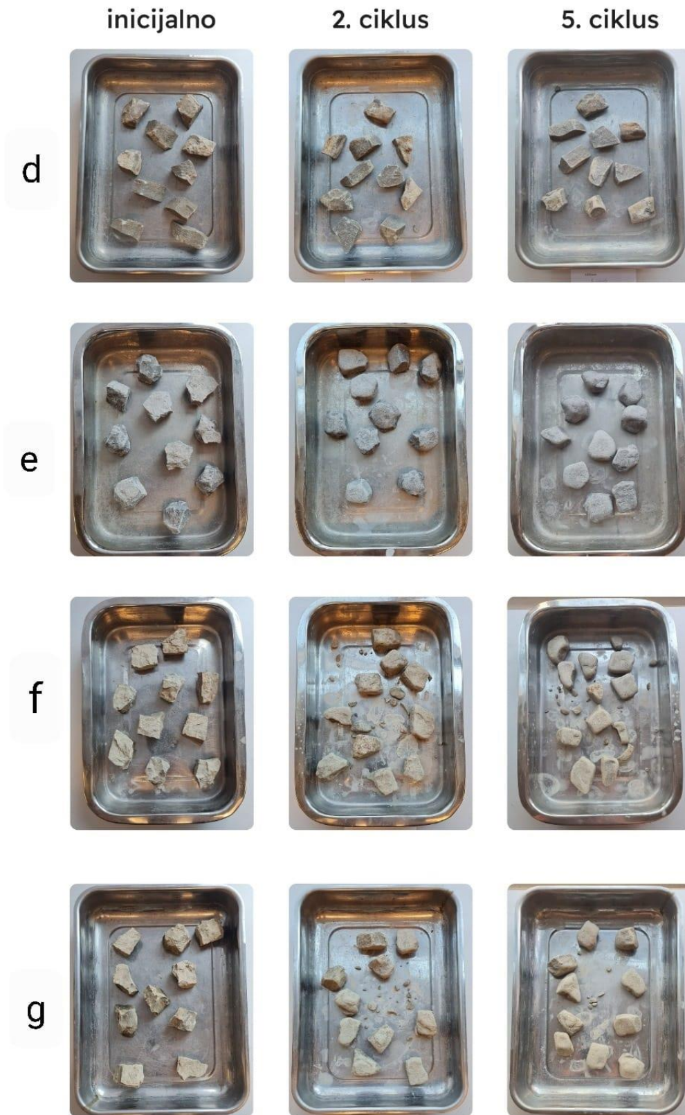
Slika 24. Uzorci prije 1.ciklusa, nakon 2. ciklusa i nakon 5.ciklusa, d– PJ(2) , e – PrahFR(2), f– PrahMW(3), g – PrahMW(2)
