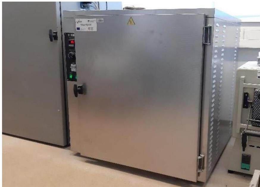
*Slika 12. Sušionik za sušenje ispitivanih uzoraka (Jakić, 2019)*
