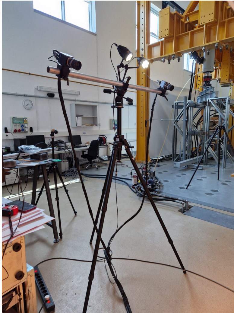
Slika 4.1: Optički mjerni sustav GOM mbH PONTOS 3D 4M
