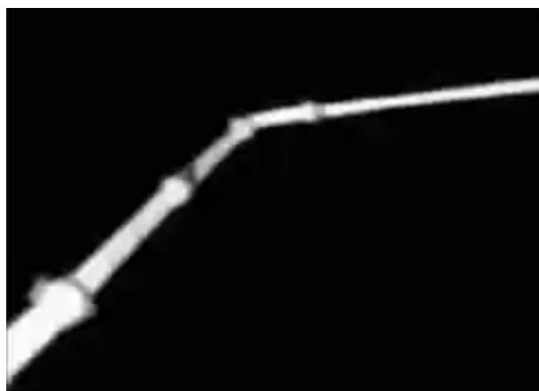
Slika 31 Toplinska slika betona koji teče kroz cijev[15]
