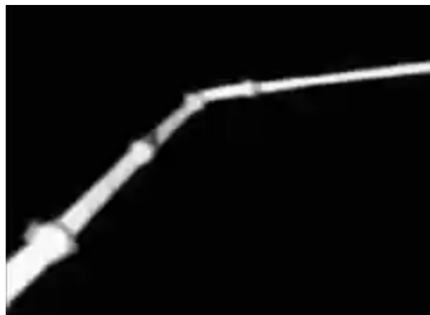
Slika 31 Toplinska slika betona koji teče kroz cijev[15]
