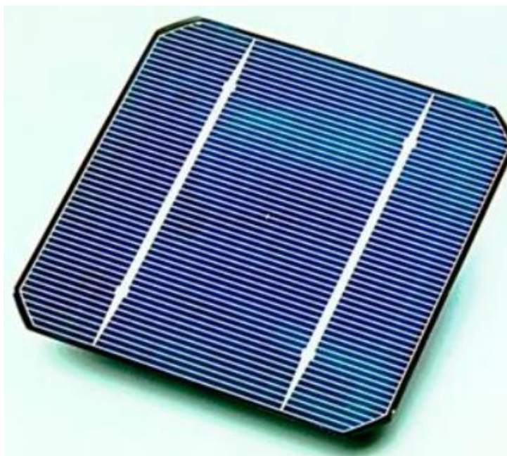
Slika 16 Konvencionalna solarna ćelija od kristalnog silicija (od 2005.). Električni kontakti napravljeni od sabirnica (veće trake srebrne boje) i prstiju (onih manjih) otisnuti su na silikonsku pločicu.[24]
