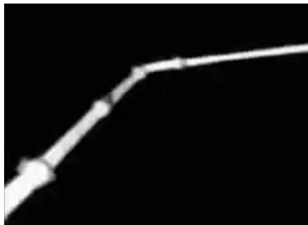
Slika 31 Toplinska slika betona koji teče kroz cijev[15]
