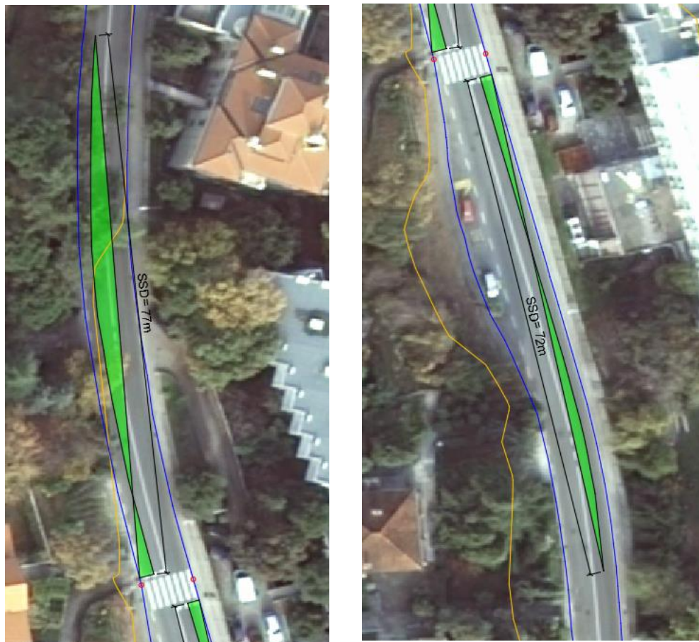
Slika 55. Grafički prikaz zaustavne preglednosti za pješački prijelazu 8 [14]
