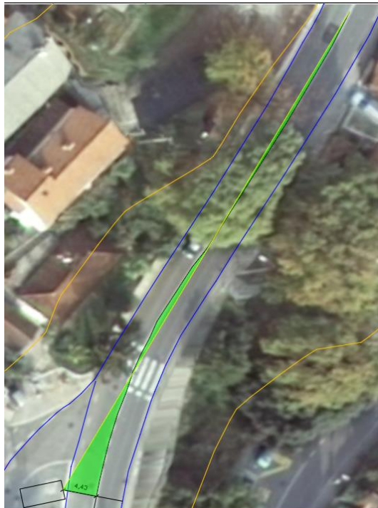
Slika 41. Grafički prikaz preglednosti za raskrižje 4 za desno skretanje (iz privoza 3 u privoz 1)
