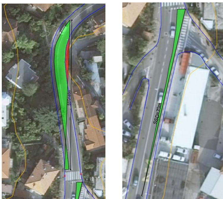
Slika 48. Grafički prikaz zaustavne preglednosti za pješački prijelaz 1 [14]
