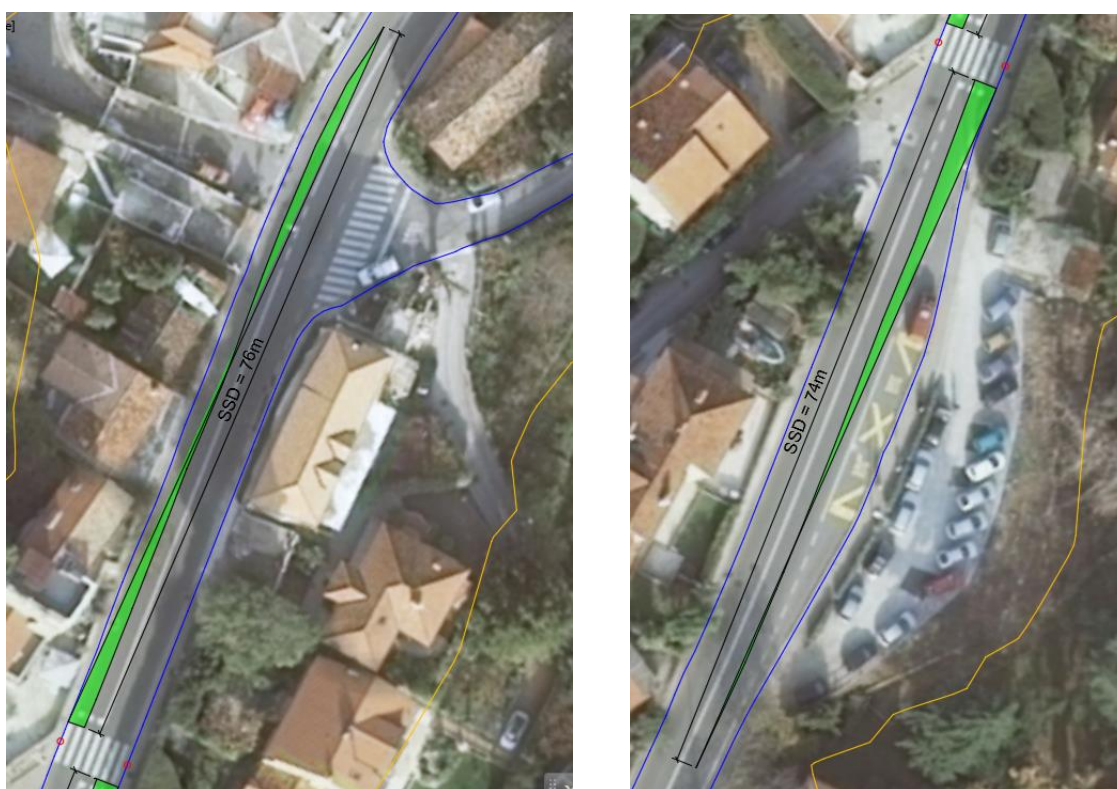
Slika 50. Grafički prikaz zaustavne preglednosti za pješački prijelaz 3 [14]
