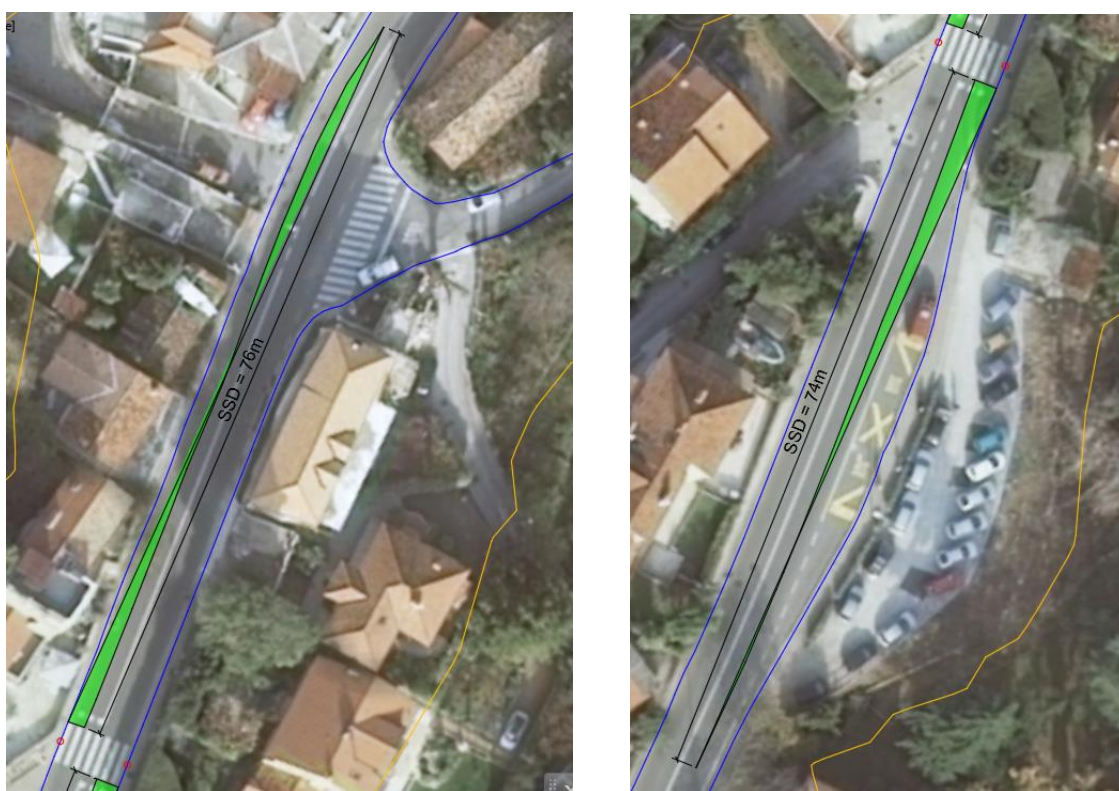
Slika 50. Grafički prikaz zaustavne preglednosti za pješački prijelaz 3 [14]
