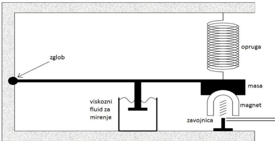
Slika 3: Vertikalni seismograf [5]
