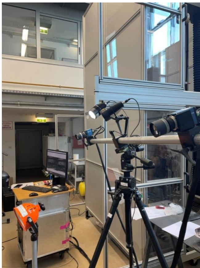
Slika 12: GOM mbH PONTOS 3D 4M
