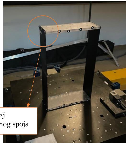
Slika 7: Okvir sa jednim zglobnim i jednim krutim spojem korišten za ispitivanja
