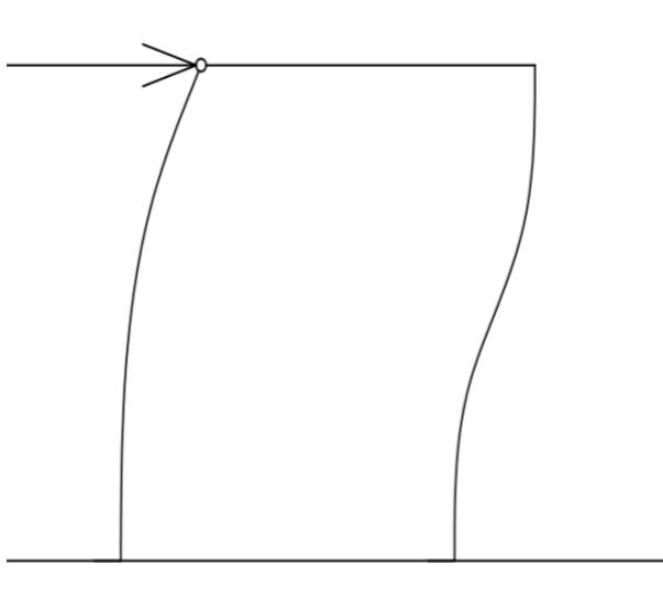
Slika 6: Teorijski 2D model okvira sa jednim zglobnim i jednim krutim spojem
