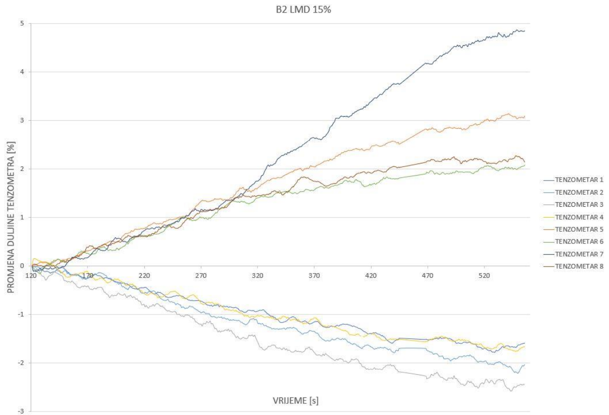
Slika 48: Promjene dužine tenzometara za B2 LMD sa 15% ispune
