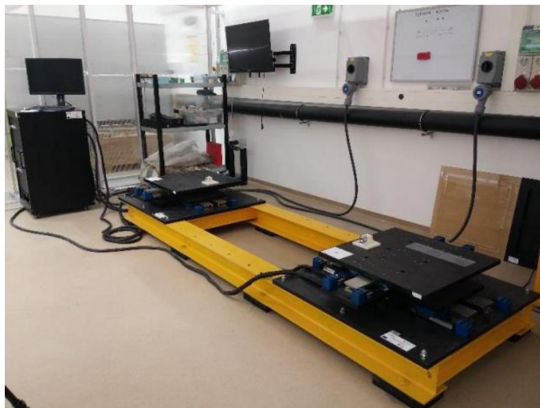
Slika 12 : Potresna platforma Quanser STI – III [8]
