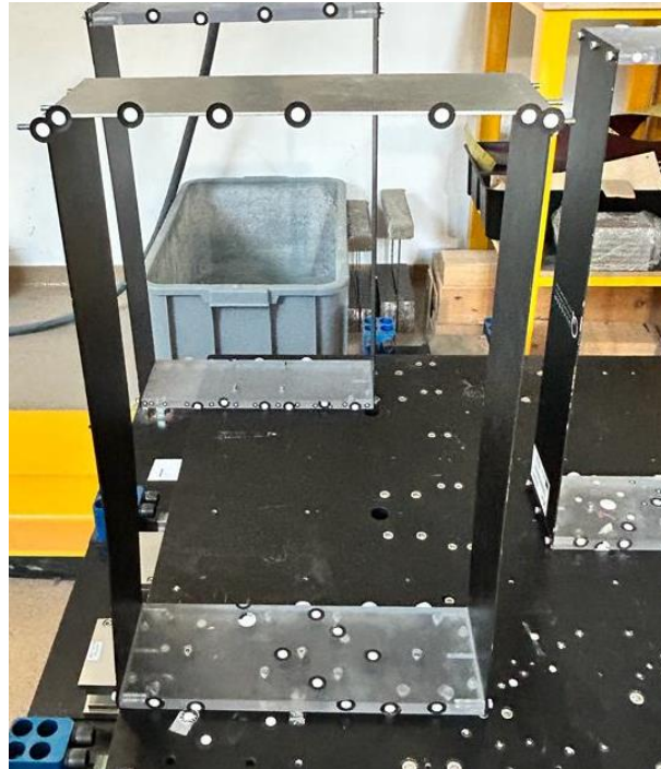
Slika 15 : Jednokatni model sa deformabilnom pločom
