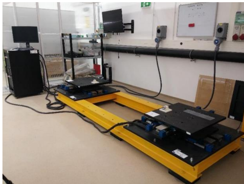
Slika 12 : Potresna platforma Quanser STI – III [8]
