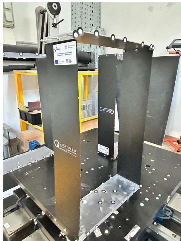
Slika 16 : Jednokatni model sa deformabilnom pločom
