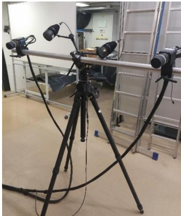
Slika 13 : Optički mjerni sustav GOM mbH PONTOS 3D 4M [8]
