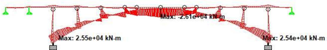
**Slika 13.** Momenti savijanja u konstrukciji uslijed stalnog opterećenja
