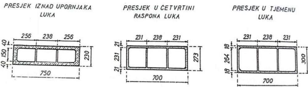
**Slika 3.** Poprečni presjek lučne konstrukcije
