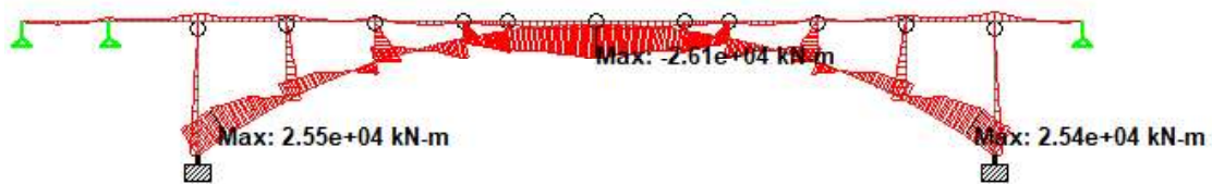
Slika 13. Momenti savijanja u konstrukciji uslijed stalnog opterećenja
