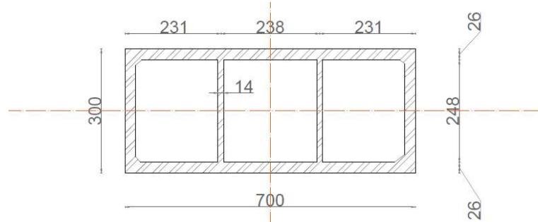
Slika 7. Pojednostavljeni poprečni presjek luka
