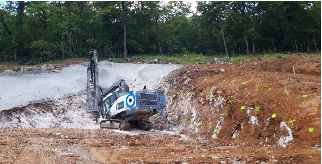
Slika 32. prikazuje minersku bušilicu Epiroc
