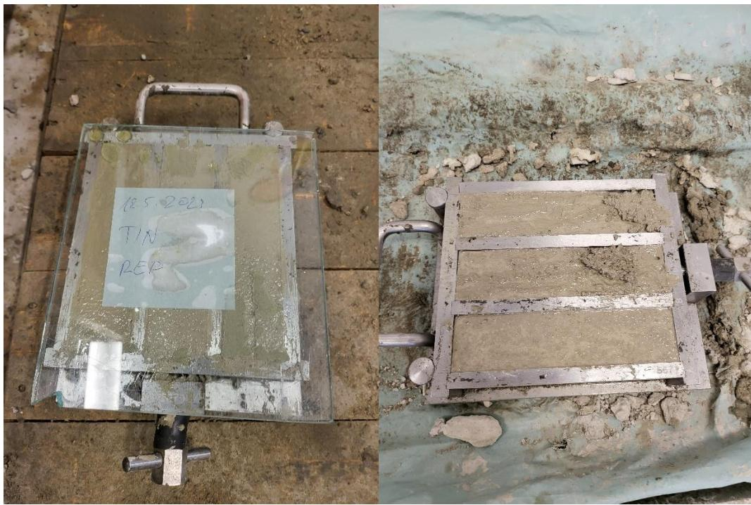
Slika 16. Ugrađivanje smjese referentne mješavine u kalupe
