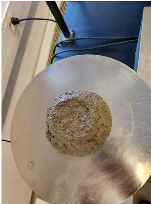
Slika 18. Rasprostiranje cementne mješavine CM10%
