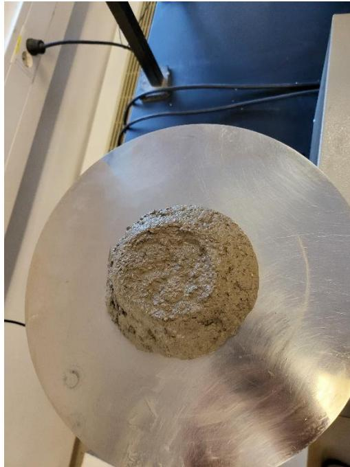
Slika 18. Rasprostiranje cementne mješavine CM10%
