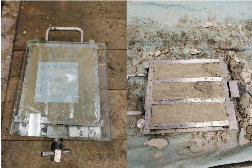
Slika 16. Ugrađivanje smjese referentne mješavine u kalupe
