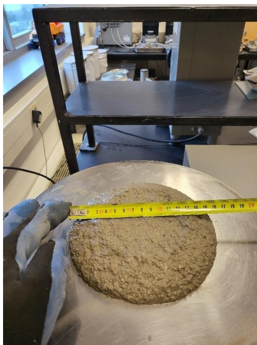
Slika 15. Promjer rasprostiranja svježeg morta (REF mješavina)
