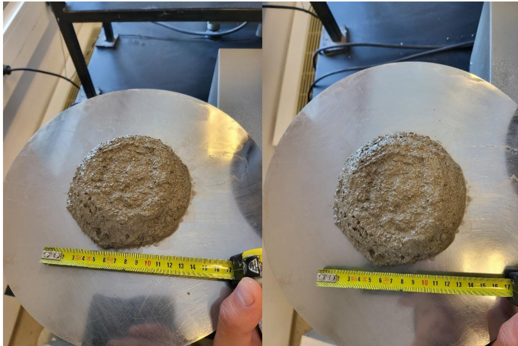
Slika 17. Rasprostiranje cementne mješavine CM5%
