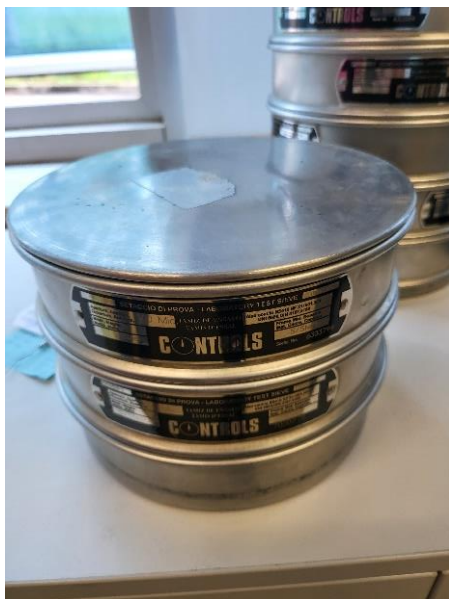
Slika 4. Korištena sita za prosijavanje uzorka cementa i cementnog otpada
