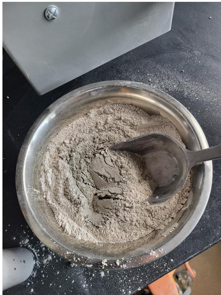
Slika 10. Izvagana količina cementa za spravljanje referente mješavine
