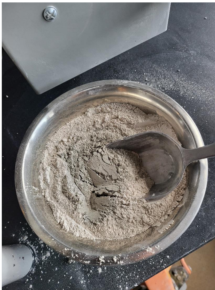
Slika 10. Izvagana količina cementa za spravljanje referente mješavine
