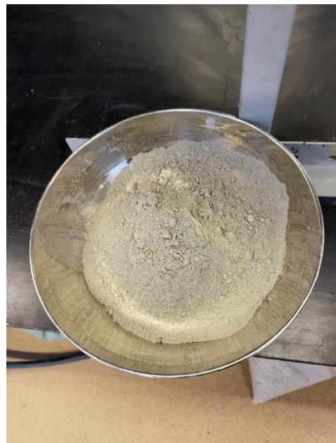
Slika 2. Prosijavanje uzorka cementnog otpadnog mulja
