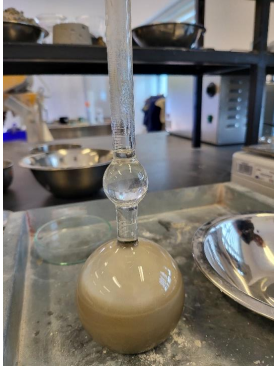
Slika 7. Očitavanje volumena na Le Chatelierovoj tikvici
