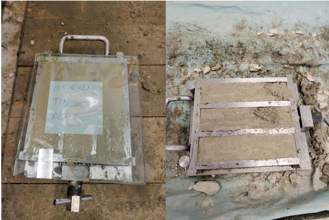
Slika 16. Ugrađivanje smjese referentne mješavine u kalupe
