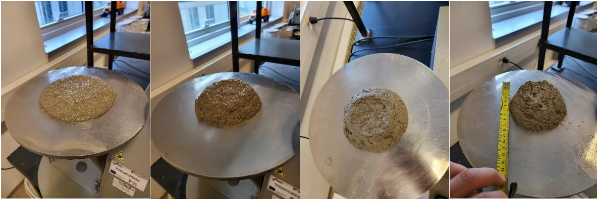
Slika 20. Usporedna rezultata ispitivanja konzistencije metodom rasprostiranja svih mješavina
