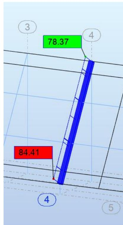
Slika 21: Opterećenje uzdužnom silom na nosaču
