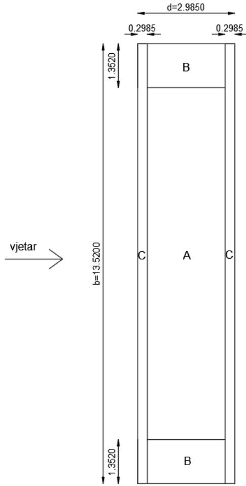
Slika 14: Tlocrt solarnih panela sa određenim zonama djelovanja vjetra
