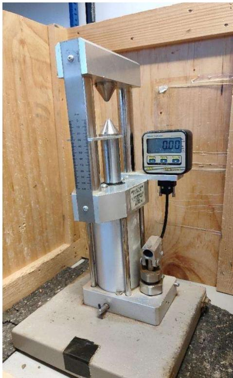
Slika 11: Uredaj za PLT ispitivanje u Laboratoriju za geotehniku Građevinskog fakulteta u Rijeci
