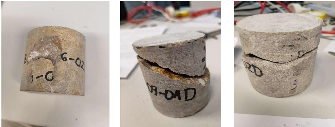
*Slika 26: Nepravilni lomovi uzoraka u dijametralnom ispitivanju*
