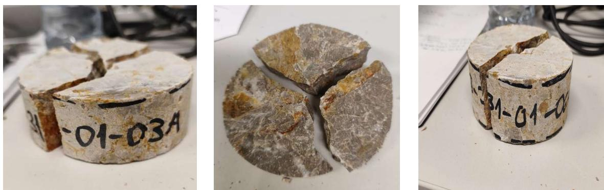
Slika 28: Uzorci ispitivani aksijalnim testom nakon loma
