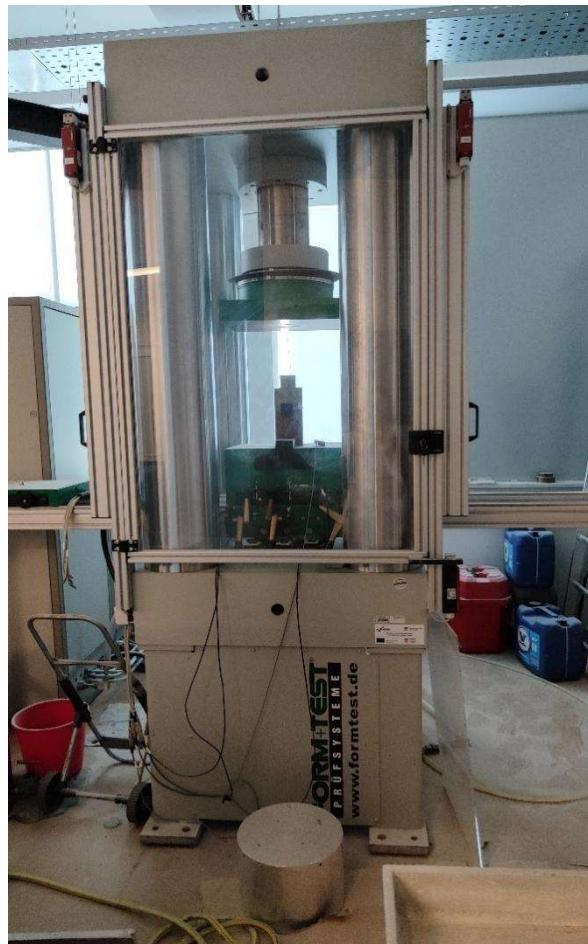
Slika 7: FORM+TESTs ALPHA 1-2000s preša za stijene u Laboratoriju za geotehniku Građevinskog fakulteta u Rijeci
