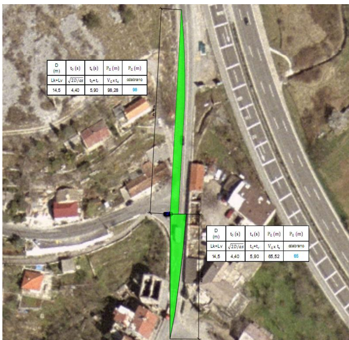
Slika 35. Raskrižje Orehovica sa proračunom duljine preglednosti
