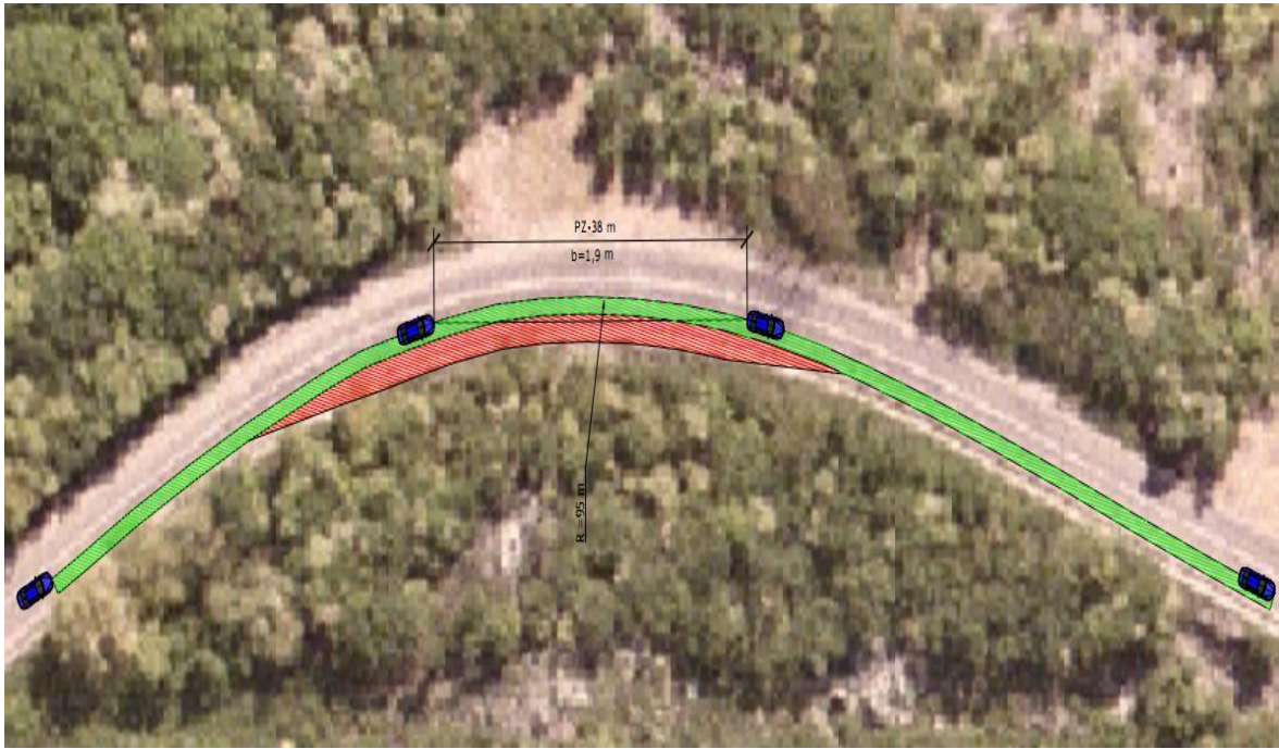
Slika 29. Preglednost horizontalne krivine R3 odabrane za analizu
