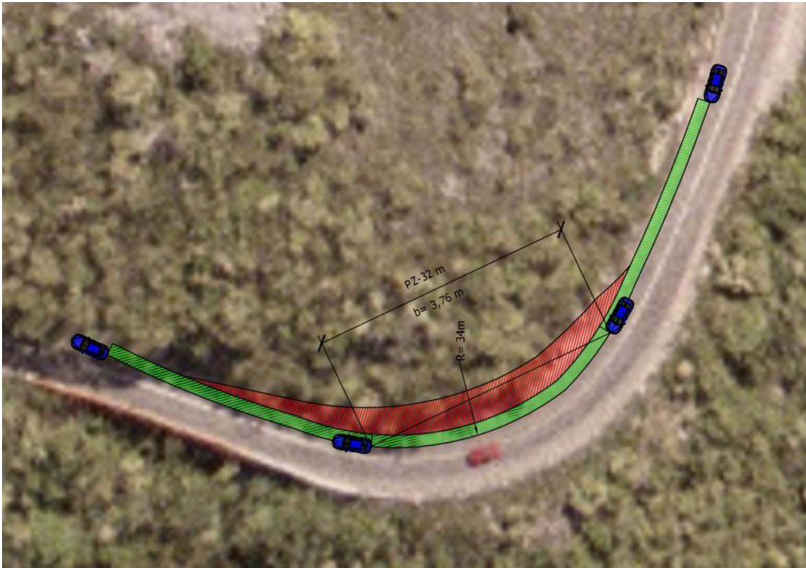
Slika 33. Preglednost horizontalne krivine R5 odabrane za analizu
