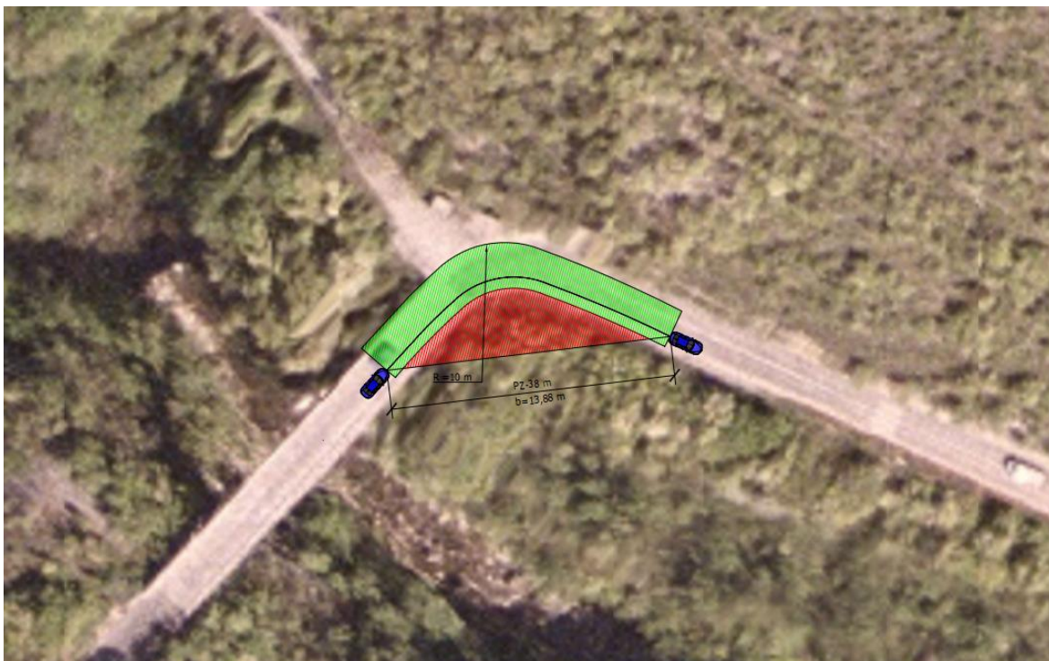
Slika 25. Preglednost horizontalne krivine R1 odabrane za analizu
