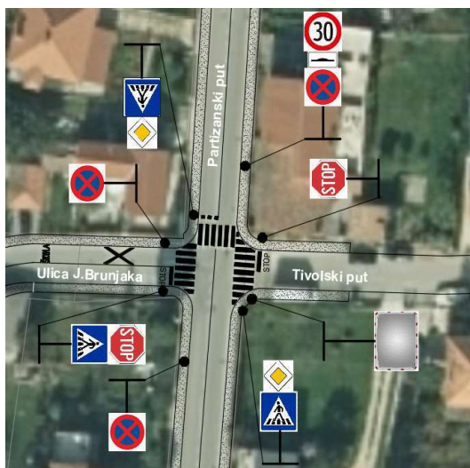
Slika 27. Prometna signalizacija na raskrižju 1
