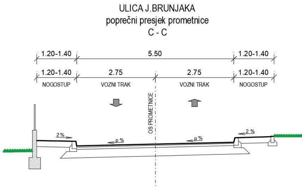
Slika 10. Poprečni presjek prometnice C - C
