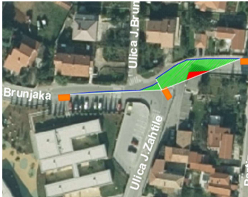
Slika 48. Preglednosti raskrižja sa skretanjem u lijevo Ulica Josipa Zahtile / Ulica Josipa Brunjaka
