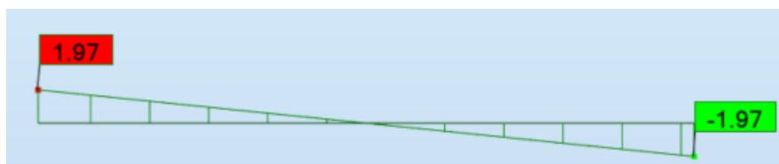
Slika 28. Vrijednost poprečne sile V_y podrožnice. Za kombinaciju 113
