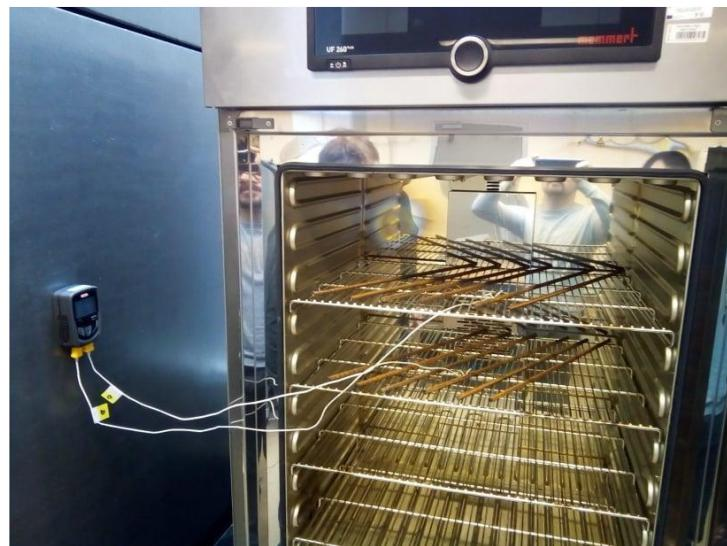
Slika 8 Sonde koje bilježe temperaturu unutar samog sušionika
