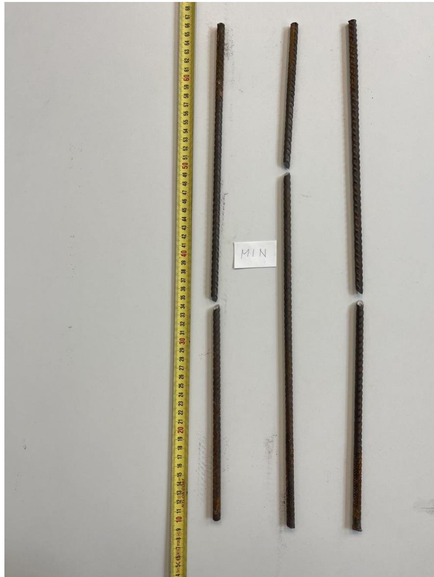
Slika 34 Uzorci nakon vlačnog ispitivanja na minimalnim brzinama
