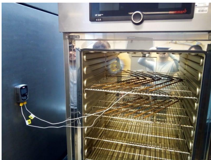
Slika 8 Sonde koje bilježe temperaturu unutar samog sušionika
