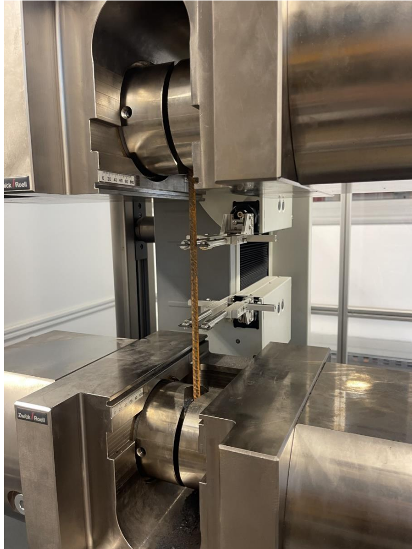
Slika 11 Hidraulična čeljust sa uzorkom neposredno prije ispitivanja
