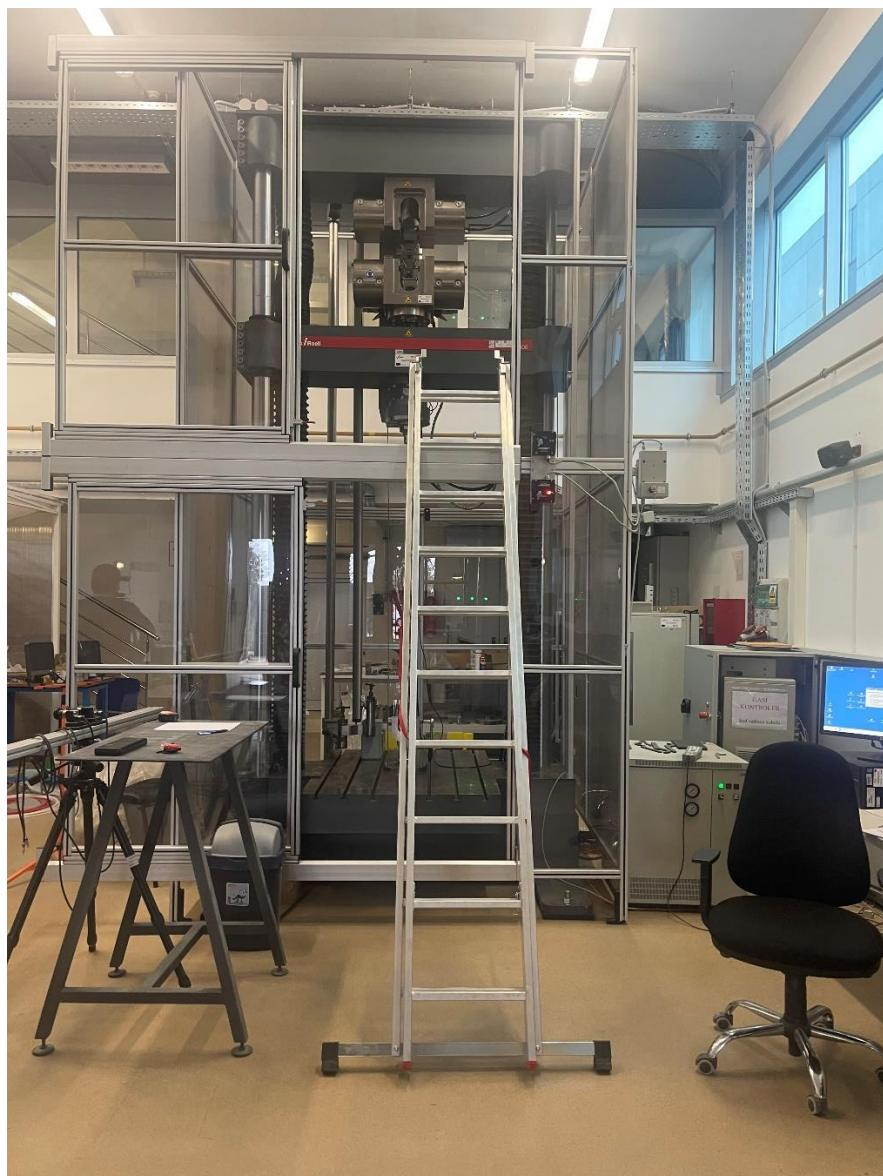
Slika 1 Tlačno-vlačni stroj za ispitivanje armature- KIDALICA
