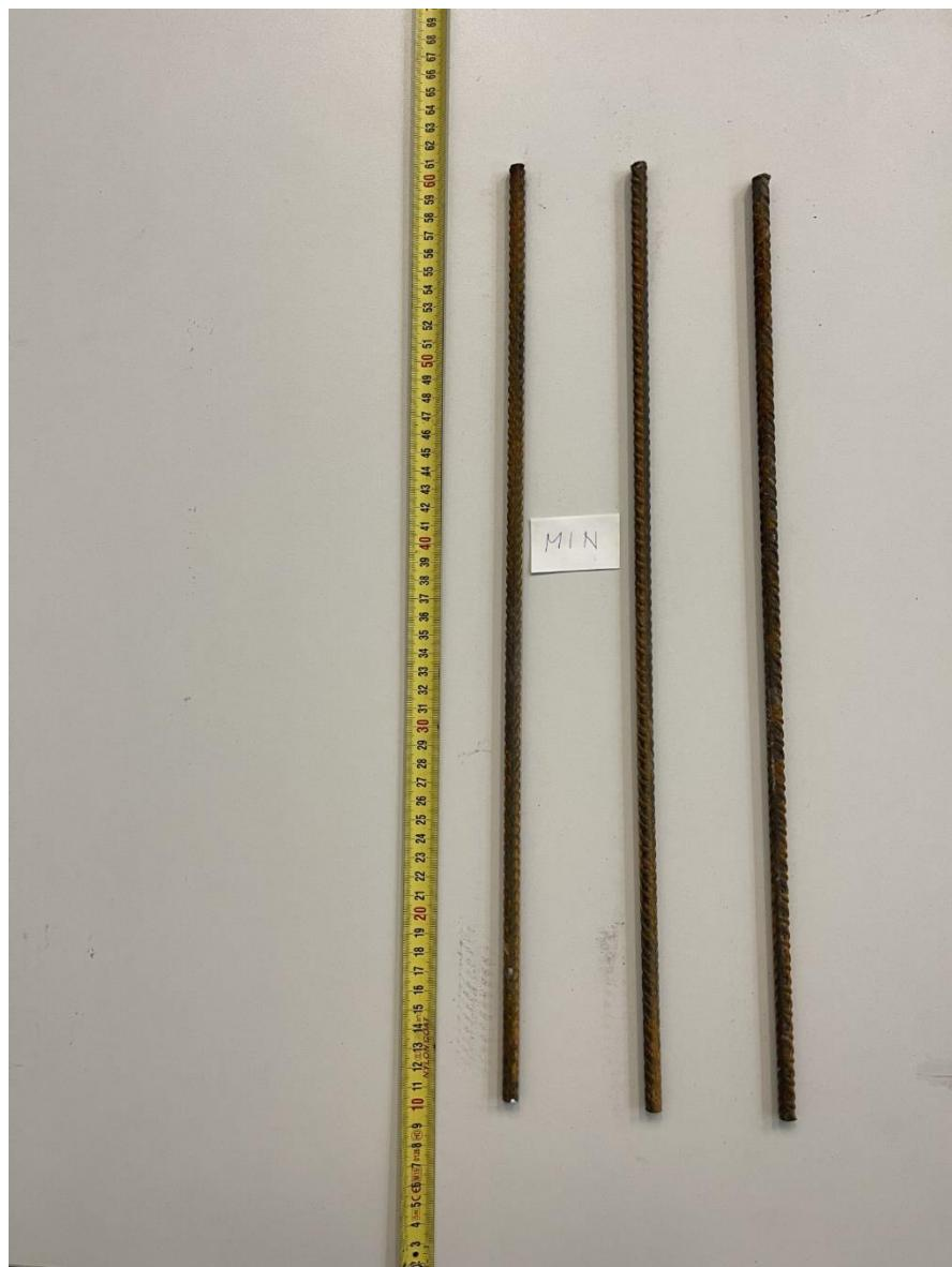
Slika 33 Uzorci prije vlačnog ispitivanja na minimalnim brzinama
