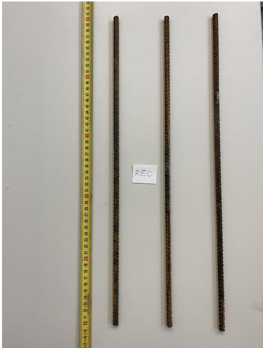
Slika 19 Uzorci prije vlačnog ispitivanja na preporučenim brzinama
