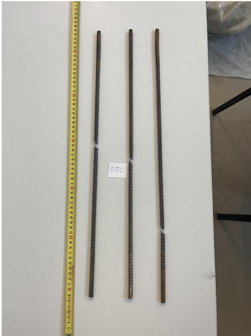
Slika 20 Uzorci nakon vlačnog ispitivanja na preporučenim brzinama
