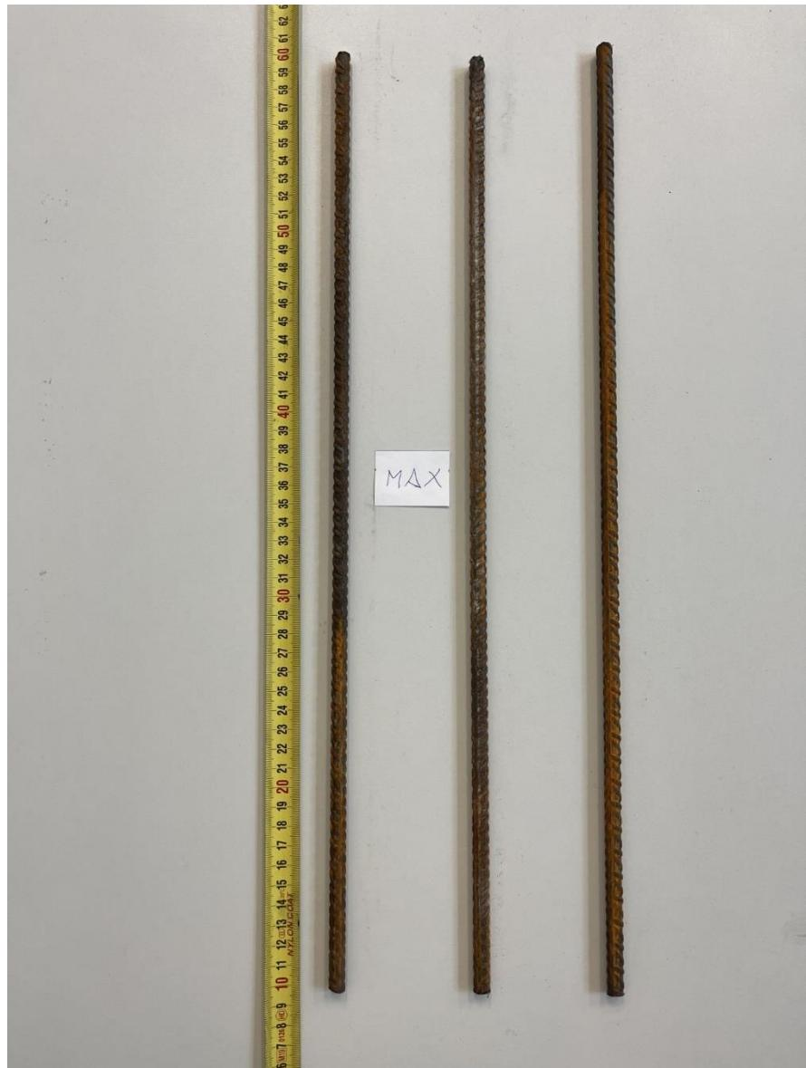
Slika 26 Uzorci nakon vlačnog ispitivanja na maksimalnim brzinama
