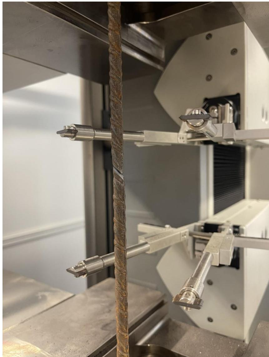
*Slika 12 Uzorak u hidrauličnoj čeljusti neposredno nakon ispitivanja*
