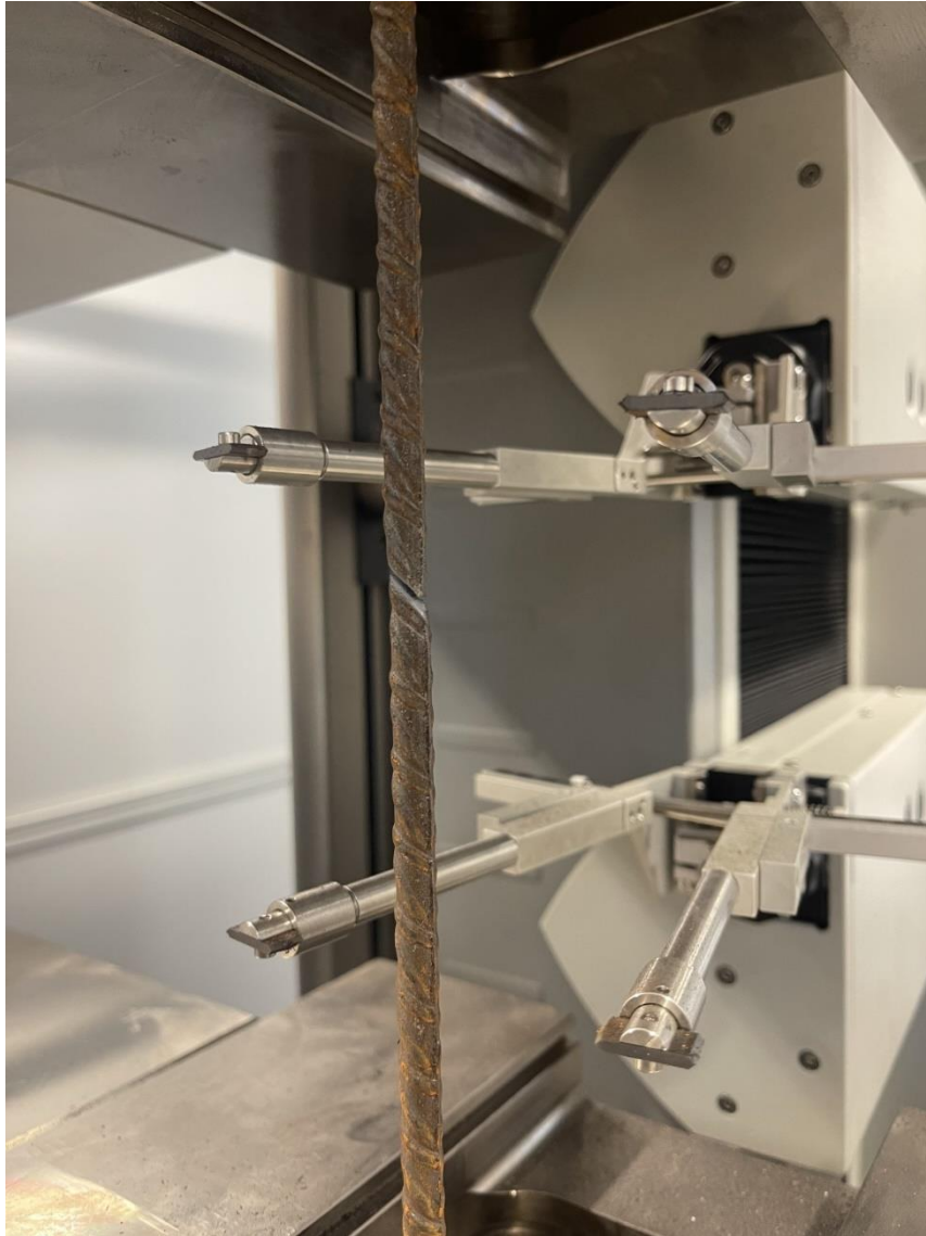
Slika 12 Uzorak u hidrauličnoj čeljusti neposredno nakon ispitivanja
