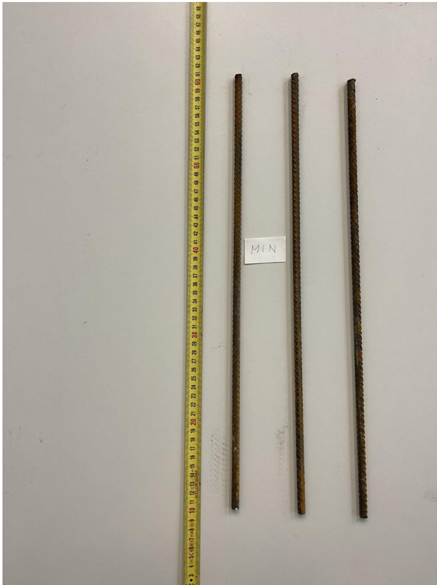
Slika 33 Uzorci prije vlačnog ispitivanja na minimalnim brzinama
