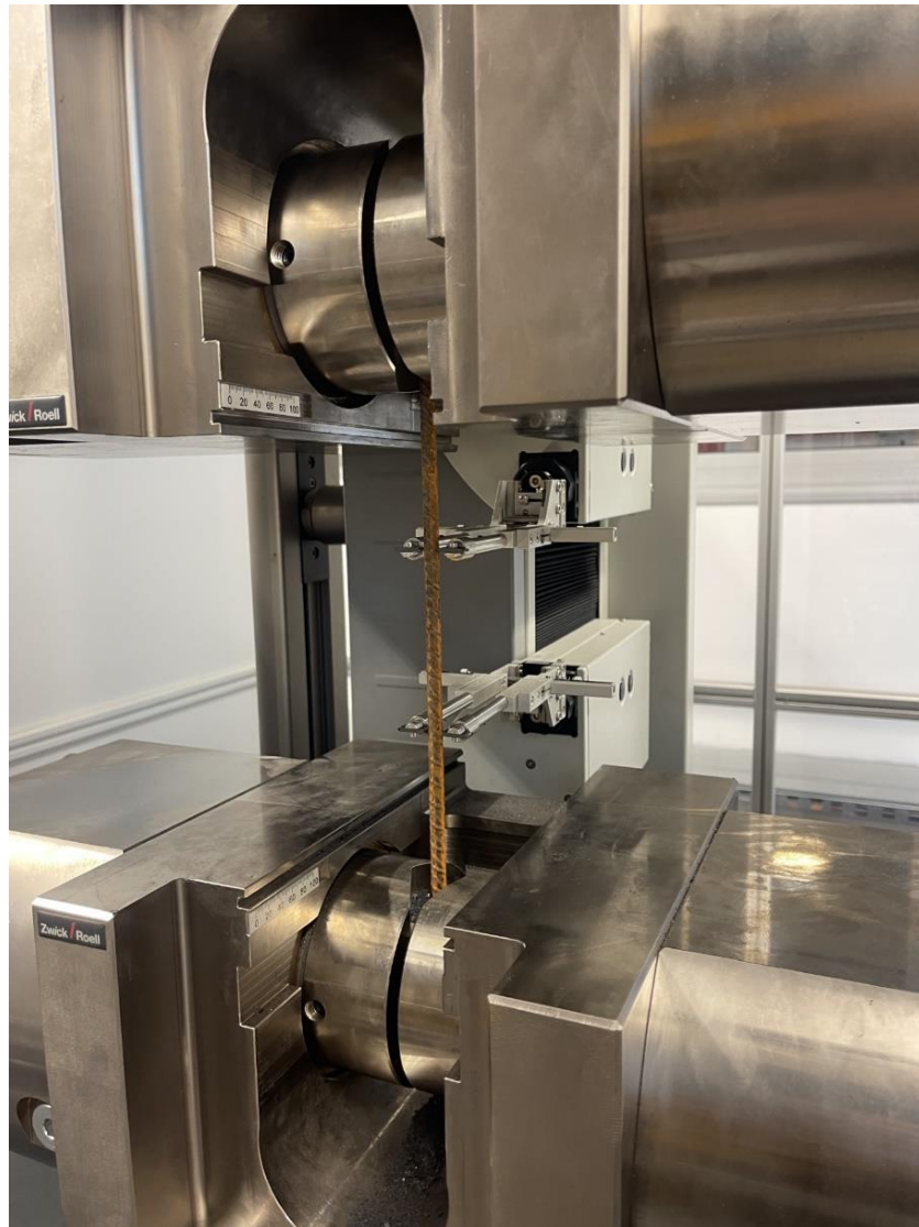
Slika 11 Hidraulična čeljust sa uzorkom neposredno prije ispitivanja
