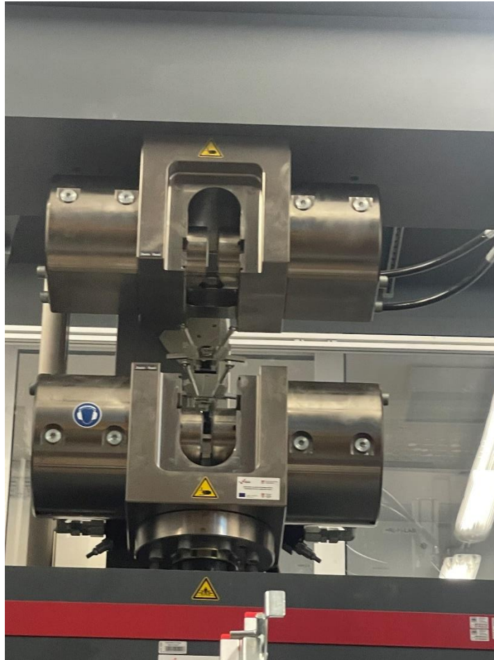
Slika 2 Stroj za vlačno ispitivanje armature- KIDALICA -hidraulična čeljust
