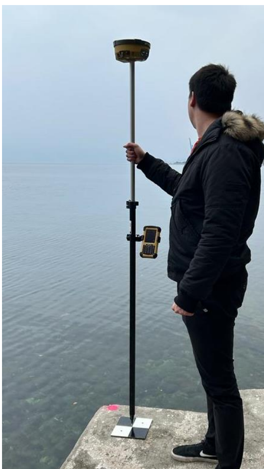
Slika 24 GPS-RTK uređaj prilikom mjerenja koordinata kontrolnih točaka
