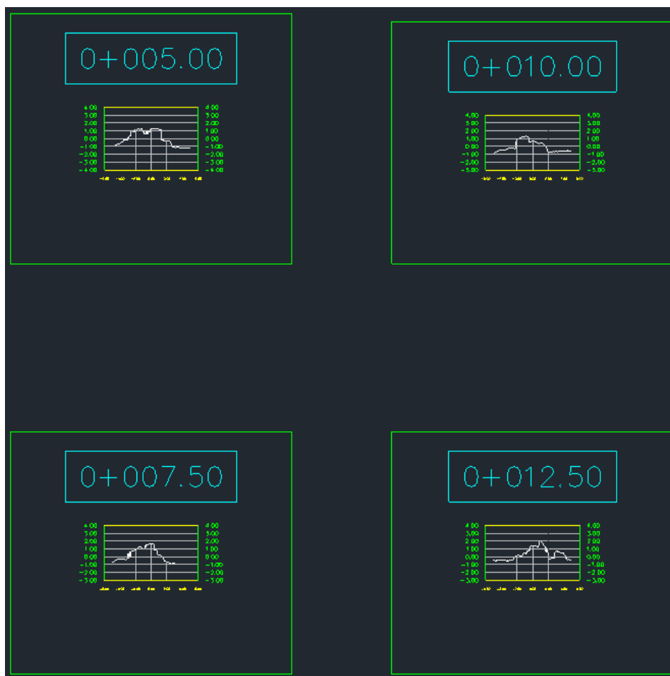
Slika 65 Prikaz presjeka kroz odabrane profile u programu Civil 3D
