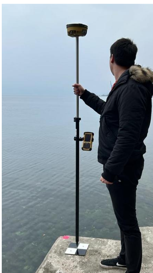
Slika 24 GPS-RTK uređaj prilikom mjerenja koordinata kontrolnih točaka
