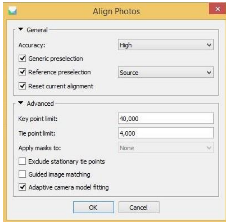
Slika 30 Parametri poravnanja fotografija u Agisoft Metashape programu
