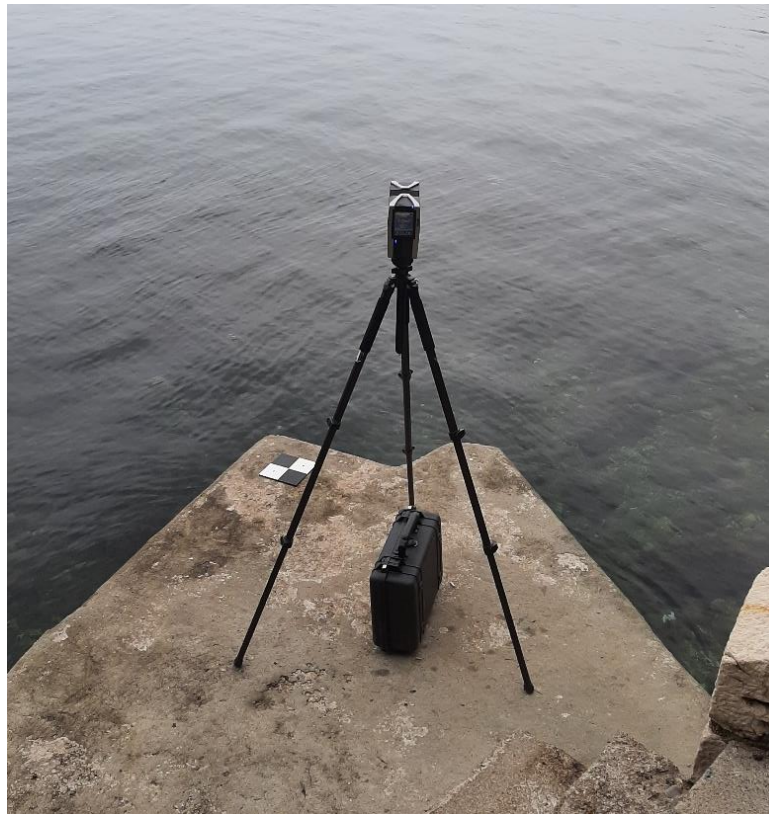
Slika 25 FARO Focus3D uređaj
