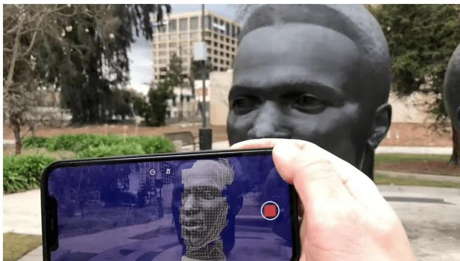
Slika 21 LiDAR skeniranje iPhone uređajem ( https://surveyinggroup.com/ )
