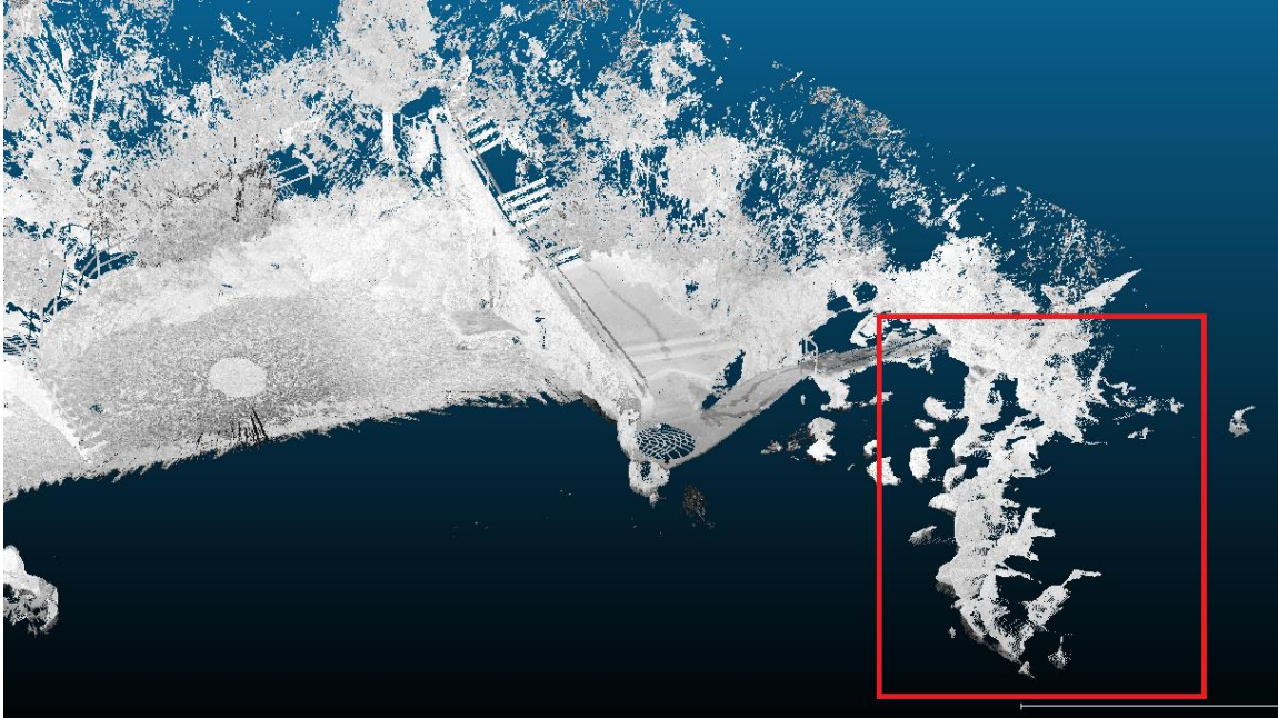
Slika 38 Označena formacija točaka samo s jedne strane lukobrana u programu CloudCompare
