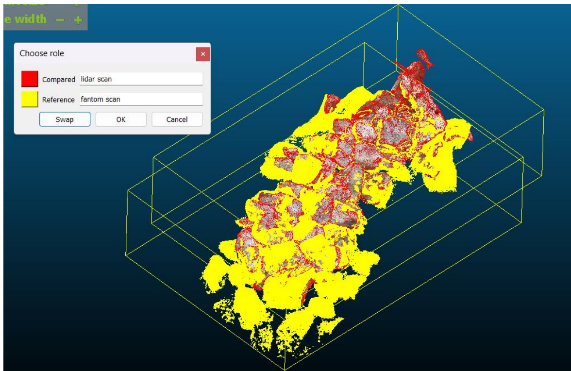
Slika 51 Uspoređivanje oblaka točaka dobivenih LiDAR-om i dronom u programu CloudCompare
