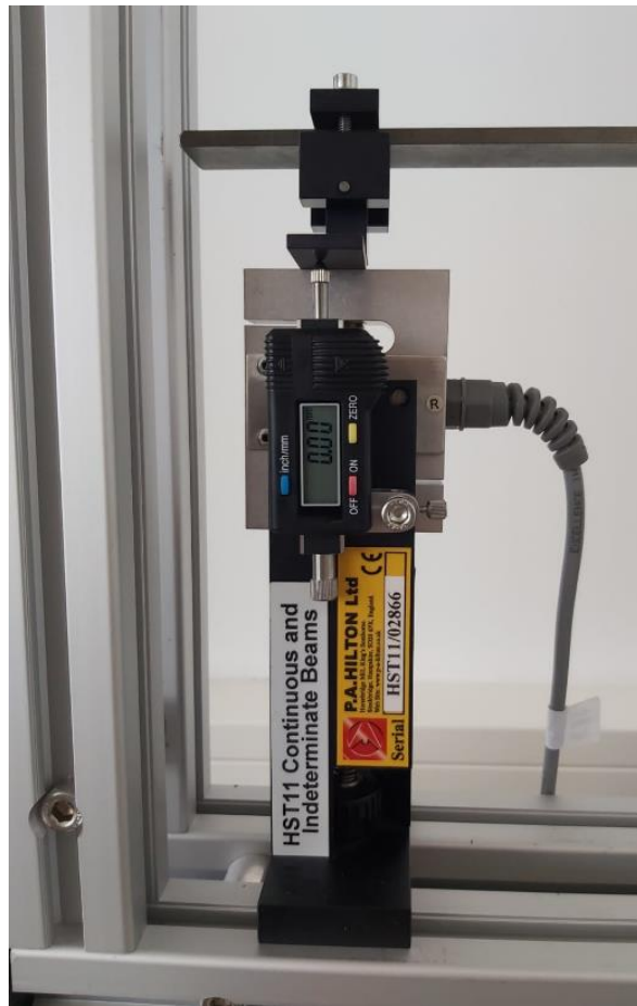
Slika 11: Lijevi oslonac s uricom za mjerenje slijeganja preciznosti 0.01 milimetara
