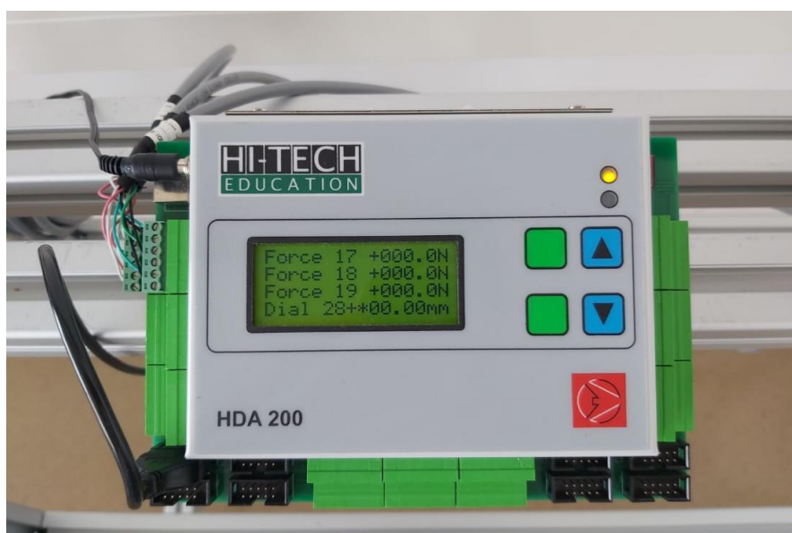
Slika 12: Uređaj za očitavanje reakcija u osloncima
