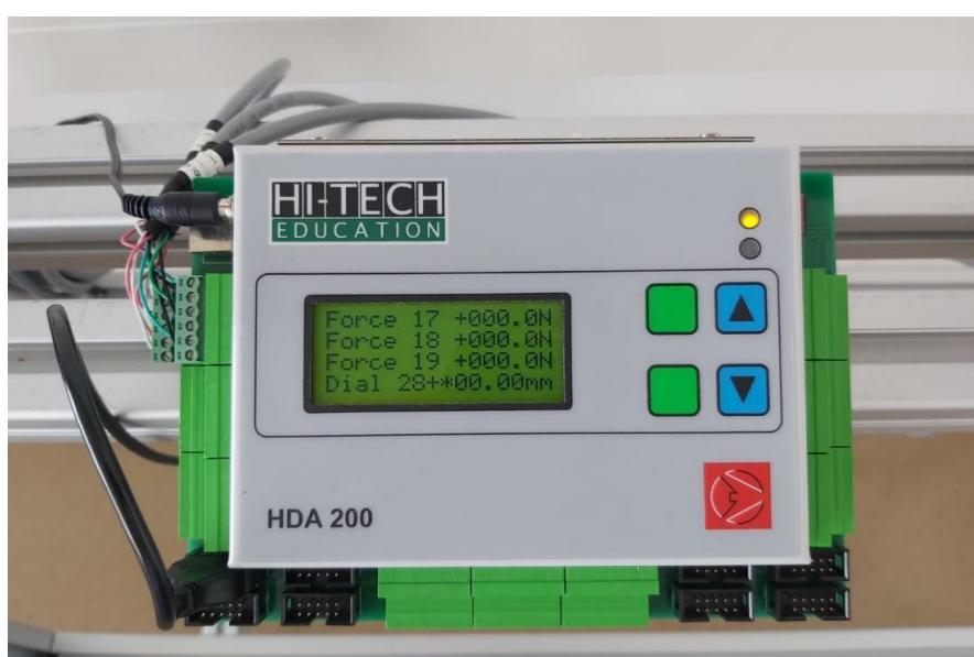
Slika 12: Uređaj za očitavanje reakcija u osloncima
