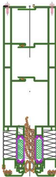
Slika 3. Horizontalni poprečni presjek vertikalnih profila fasadnog elementa
