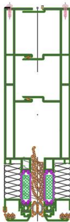
Slika 3. Horizontalni poprečni presjek vertikalnih profila fasadnog elementa
