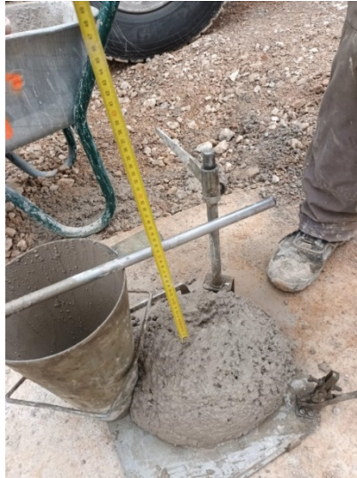
Slika 28. Primjer mjerenja konzistencije svježeg betona (autor)
