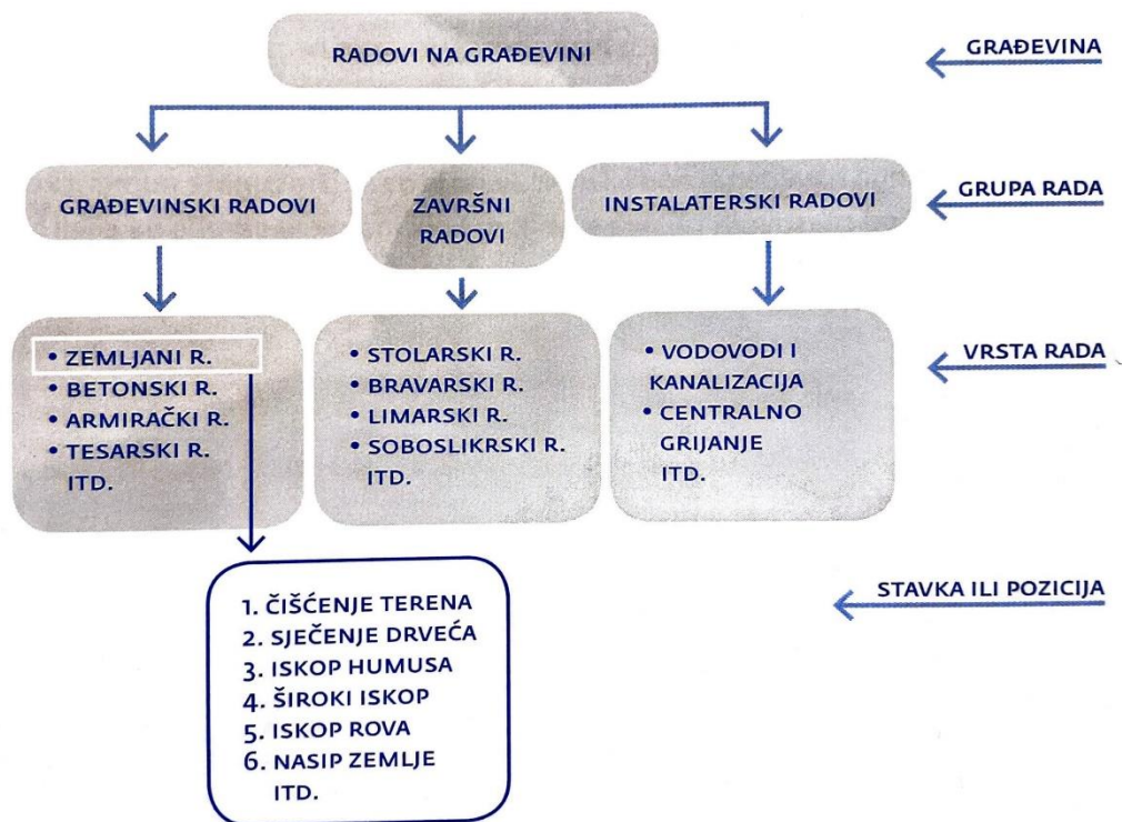
Slika 8. Prikaz podjele radova na građevini [1]
