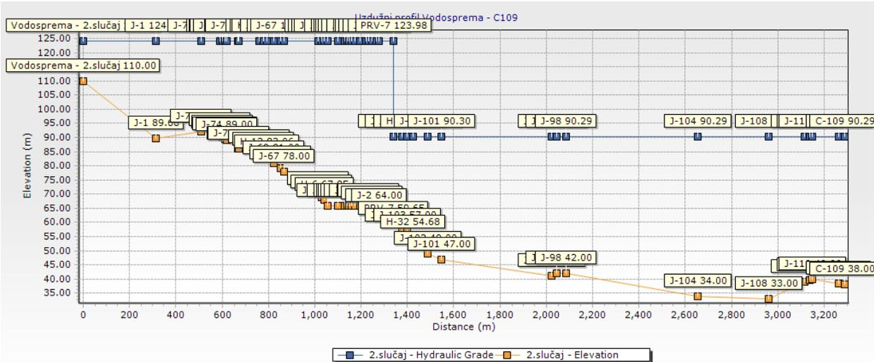
Slika 55: Uzdužni profil dionice Vodosprema - C-109 – Varijanta 2
