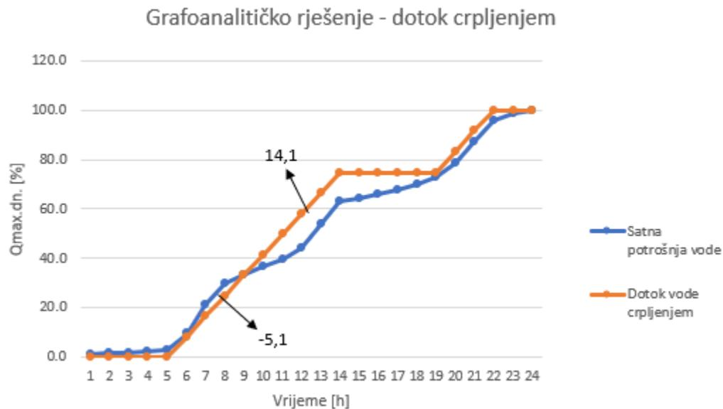
Slika 11: Grafoanalitičko rješenje dotoka vode u vodospremu crpljenjem
