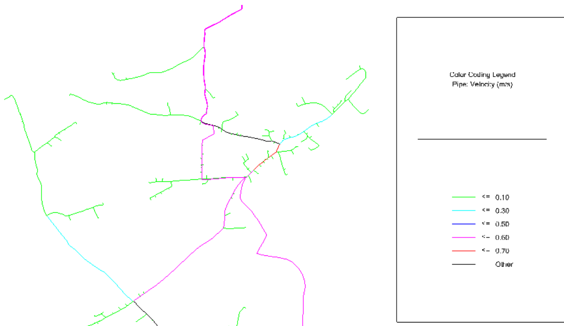
Slika 60: Prikaz promjene brzina toka pomoću “Color Coding” opcije, a) - za vrijeme potrošnje vode upola manje od maksimalne satne potrošnje vode (20 h), b) – za vrijeme maksimalne satne potrošnje vode (7 h)
