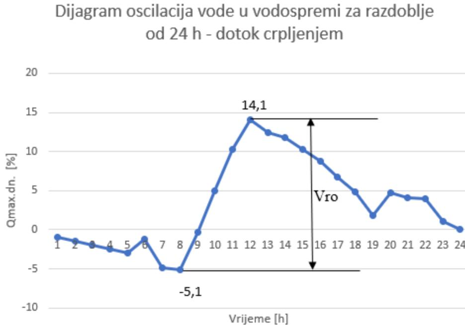
Slika 12: Dijagram oscilacija vode u vodospremi – dotok crpljenjem
