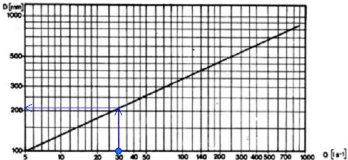
Slika 6: Dijagram ovisnosti unutarnjeg promjera cijevovoda i protoka [10]
