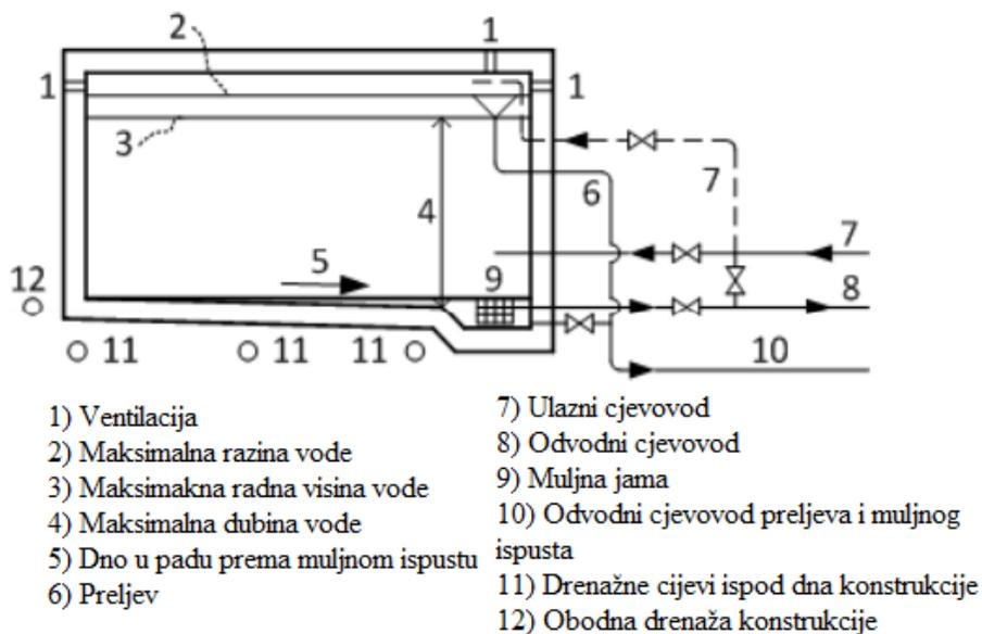
Slika 8: Pojednostavljeni prikaz vodospreme i njezinih osnovnih dijelova [9]
