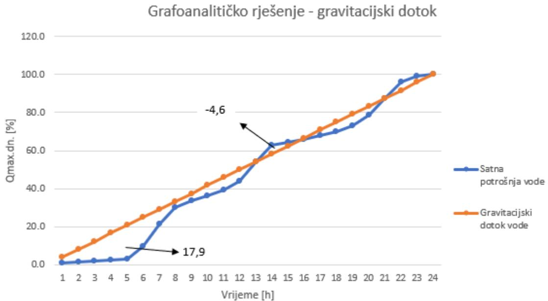
Slika 9: Grafoanalitičko rješenje gravitacijskog dotoka vode u vodospremu
